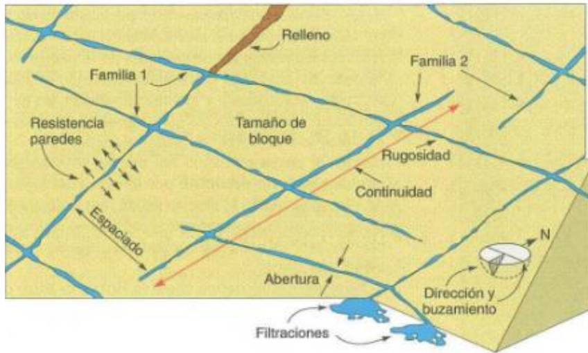
Figura 4. Representación esquemática de las propiedades de las discontinuidades (Hudson, 1989).
