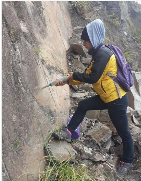
Fotografía 1. Medición de la Resistencia de las rocas con el Martillo de Schmidt.
