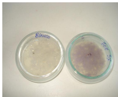
Fig. 7 Ensayo cualitativo de enzimas para hongo # 70M
