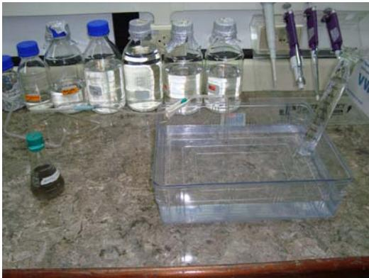
Graf 3. Medición del volumen de gas sulfhídrico desprendido
