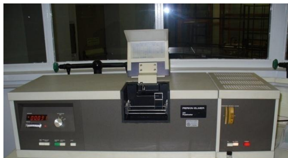
Fotografía Nº 8. Polarímetro PERKIN-ELMER 241 Elaboración: La Autora
