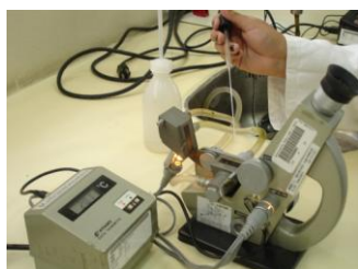
Fotografía N° 6. Muestra en el refractómetro Elaboración: La Autora
