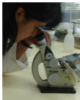
Fotografía N° 7. Medida del índice de refracción Elaboración: La Autora
