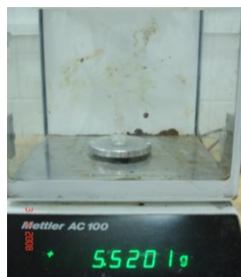
Fotografía Nº 5. Peso del picnómetro con aceite Elaboración: La Autora
