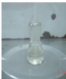
Fotografía Nº 4. Picnómetro con aceite Elaboración: La Autora
