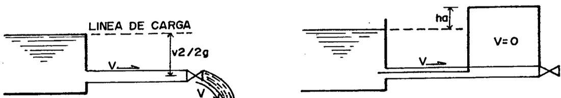
En el caso del cierre de una válvula, la fuerza viva con que el agua estaba animada se convertiría en trabajo, determinando en las paredes de la tubería presiones superiores a la carga inicial.
