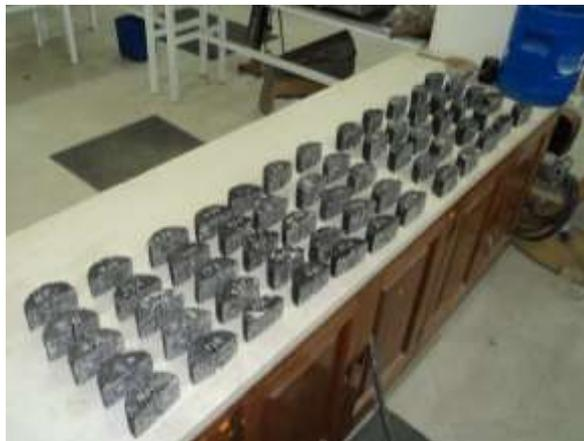
Figura 20. Probetas luego del ensayo SCB.
