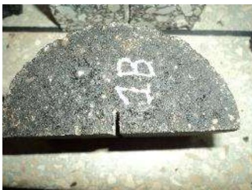
Figura 13. Probeta SCB.
