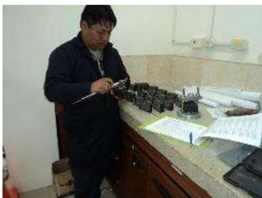
Figura 14. Medición de geometría de probeta SCB.
