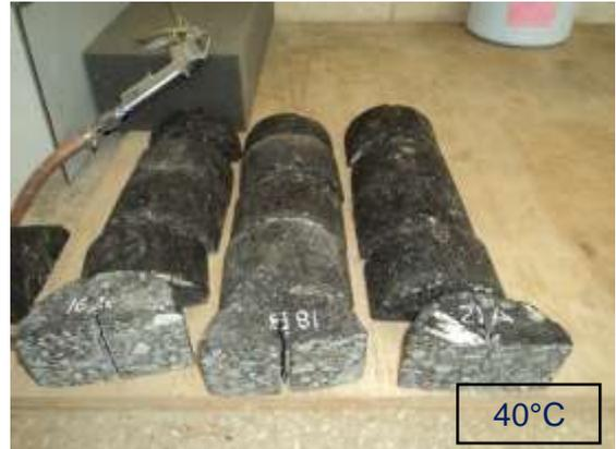
Figura 30-B. Probetas a 40°C, mezcla de  $\frac{1}{2}$ ".
