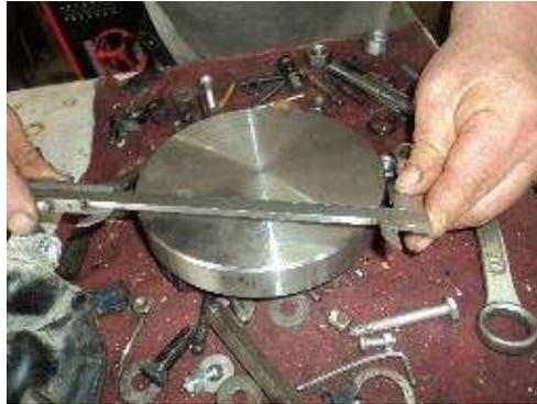
Figura 9. Fabricación de base para prueba SCB.
