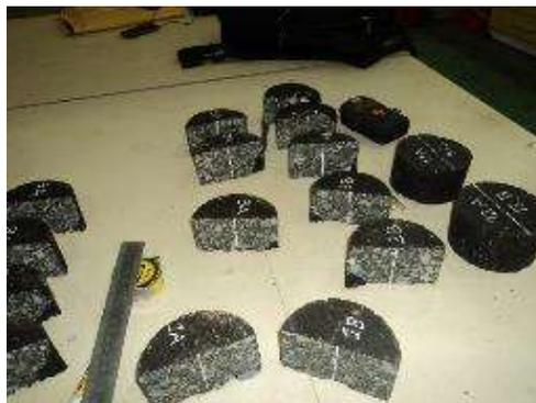
Figura 7. Preparación para corte de ranura.
