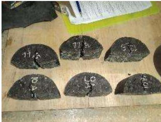
Figura 19. Probetas con fisura luego del ensayo SCB.
