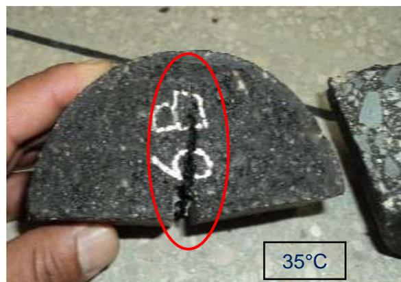
Figura 29-B. Fisura a 35°C, mezcla de  $\frac{1}{2}$ ".
