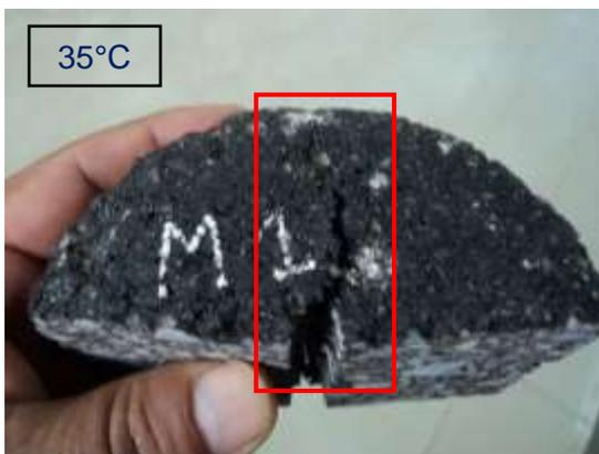
Figura 29-A. Fisura a 35°C, mezcla de  $\frac{3}{4}$ ".
