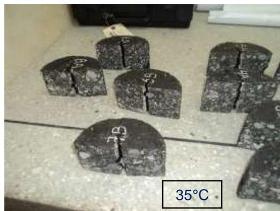
Figura 28-B. Probetas a 35°C, mezcla de  $\frac{1}{2}$ ".
