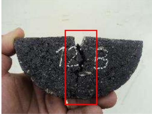
Figura 18. Fisura en probeta luego del ensayo SCB.
