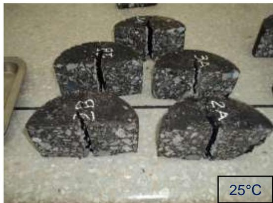
Figura 24-B. Probetas a 25°C, mezcla de  $\frac{1}{2}$ ".
