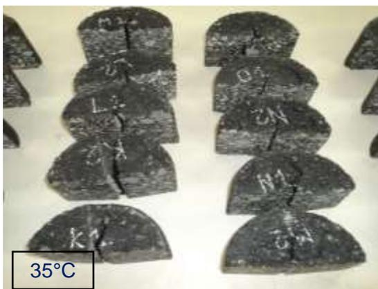
Figura 28-A. Probetas a 35°C, mezcla de  $\frac{3}{4}$ ".
