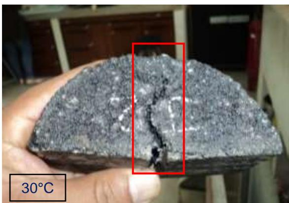
Figura 27-A. Fisura a 30°C, mezcla de  $\frac{3}{4}$ ".
