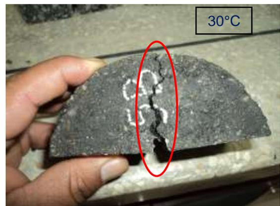
Figura 27-B. Fisura a 30°C, mezcla de  $\frac{1}{2}$ ".
