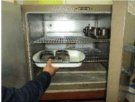
Figura 15. Colocar probetas en el horno.
