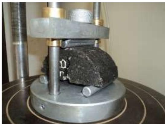
Figura 17. Probeta SCB luego del ensayo.
