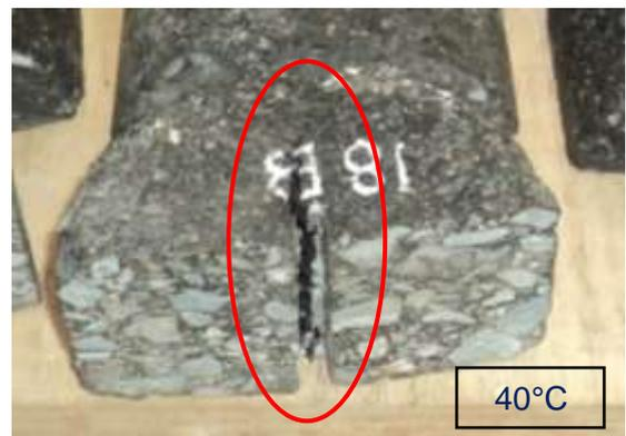
Figura 31-B. Fisura a 40°C, mezcla de  $\frac{1}{2}$ ".
