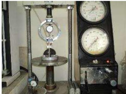
Figura 16. Ejecución del ensayo SCB.
