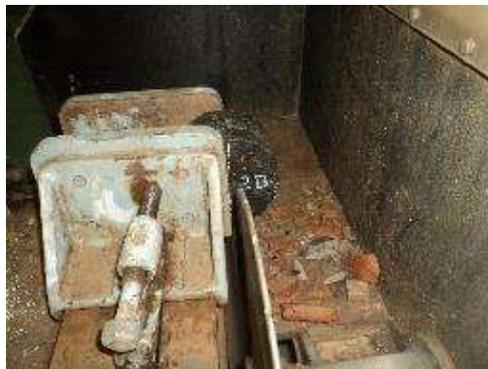
Figura 6. Colocación y corte de briquetas.
