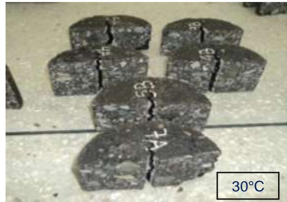
Figura 26-B. Probetas a 30°C, mezcla de  $\frac{1}{2}$ ".
