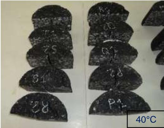
Figura 30-A. Probetas a 40°C, mezcla de  $\frac{3}{4}$ ".
