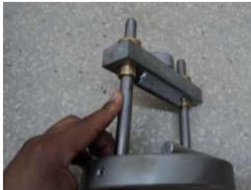
Figura 10. Base para prueba SCB.
