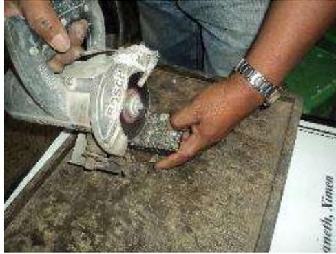
Figura 8. Corte de ranura en briqueta semicircular.
