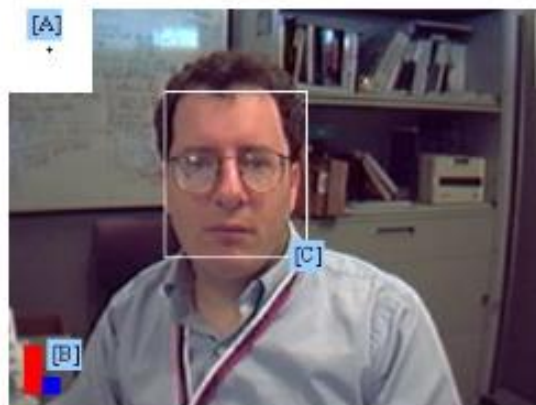
Figura 15: Salida del seguidor de caras realizado con un filtro de Kalman
