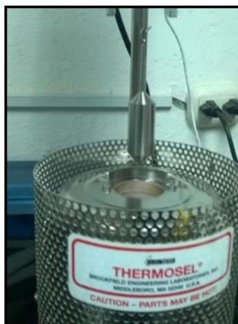
Figura 20: Aguja utilizada para el ensayo Fuente: Laboratorio de pavimentos de la CIA. HeH. Elaborado por: El autor
