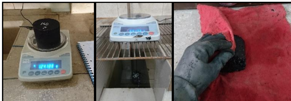
Figura 37. Proceso de gravedad específica bulk
