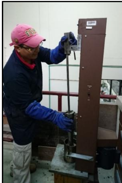
Figura 34. Compactado de las briquetas
