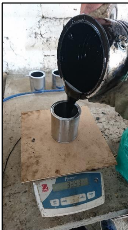
Figura 17. Preparación de la mezcla cera-asfalto
