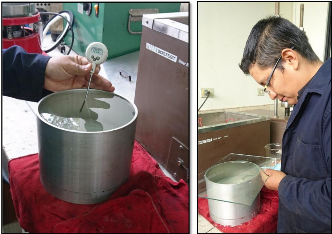
Figura 41. Llenado del picnómetro de vacío
