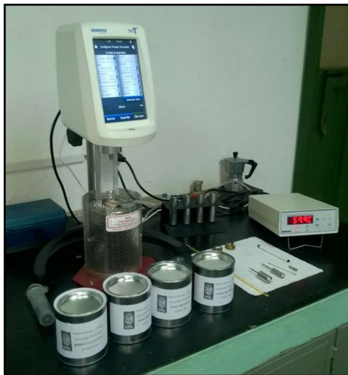
Figura 19. Viscosímetro Brookfield y muestras de asfalto Fuente: Laboratorio de pavimentos de la compañía HeH. Elaborado por: El autor
