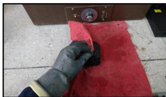
Figura 38. Briquetas en el baño maría a 60°C y secado de la superficie
