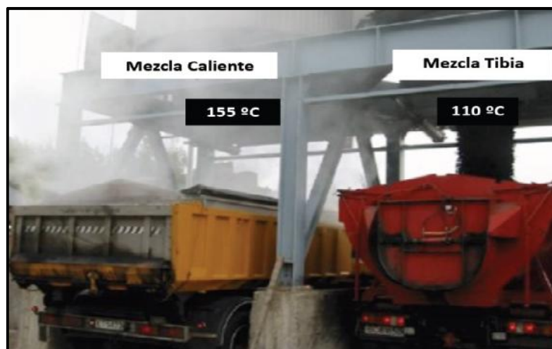
Figura 6. Comparación de la Emisión de gases entre HMA y WMA Fuente: Ulloa A., “Mezclas Asfálticas Tibias (MAT)”. Boletín Técnico Vol. 2. N°13. Programa de Infraestructura del Transporte. Elaborado por: El autor
