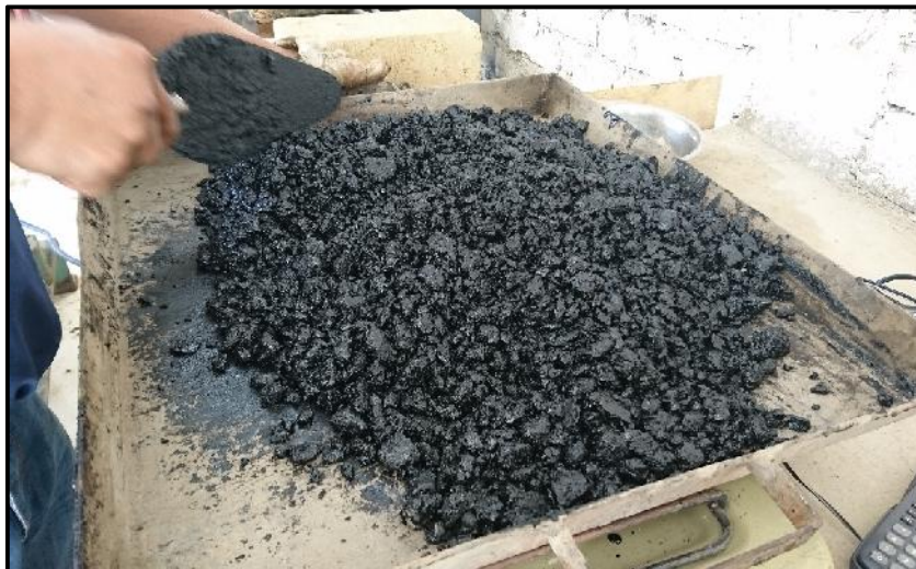
Figura 33. Mezcla homogénea y 100% cubierta los agregados Fuente: Propia Elaborado por: El autor
