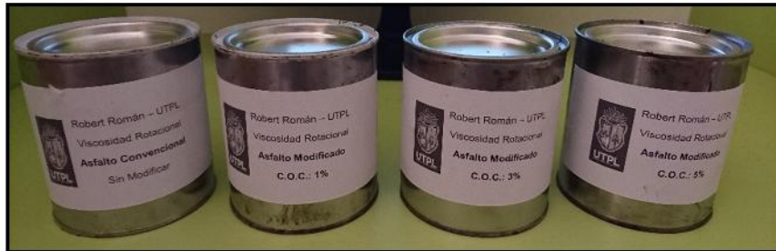
Figura 18. Muestras de asfalto para ensayo de viscosidad Fuente: Propia Elaborado por: El autor
