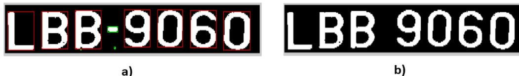
**Figura 2. 17** a) Placa binarizada complementada con áreas detectadas, b) Placa sin redundancias.
