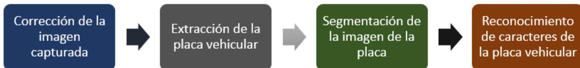
**Figura 2. 11** Fases del sistema propuesto por Ceballos, S. para la detección de placas vehiculares.
