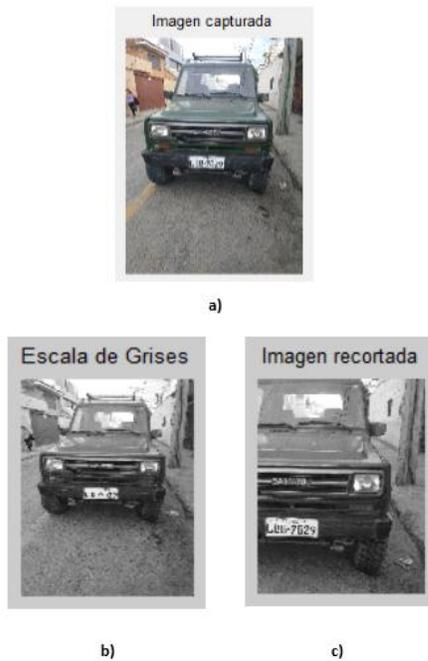
**Figura 2. 3** a) Imagen original, b) imagen en escala de grises, c) imagen recortada.
