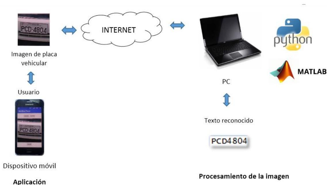
**Figura 4. 2** Esquema conceptual del funcionamiento del sistema
