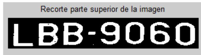
**Figura 2. 34** Recorte de la placa que contiene el área de los caracteres.
