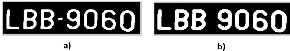
**Figura 2. 26** a) Aplicación del filtro mediana, b) dilatación de la placa vehicular
