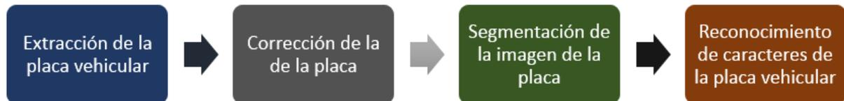
**Figura 2. 19** Fases del sistema propuesto por Guerrero, P. para la detección de placas vehiculares.
