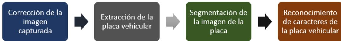
**Figura 2. 28** Fases del sistema para la detección de placas vehiculares
