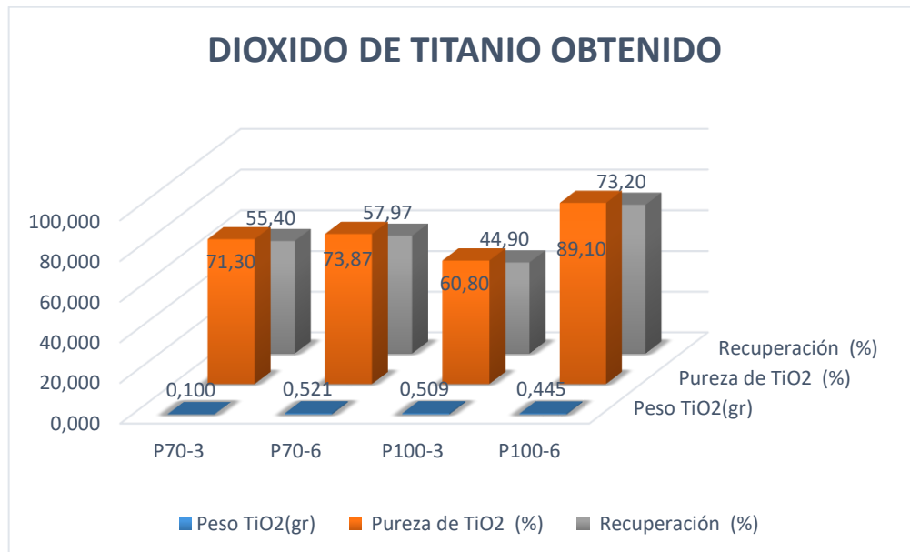
Figura 21. Relación entre peso, pureza y recuperación de TiO 2 obtenido. Fuente: Flores, A. (2017)
