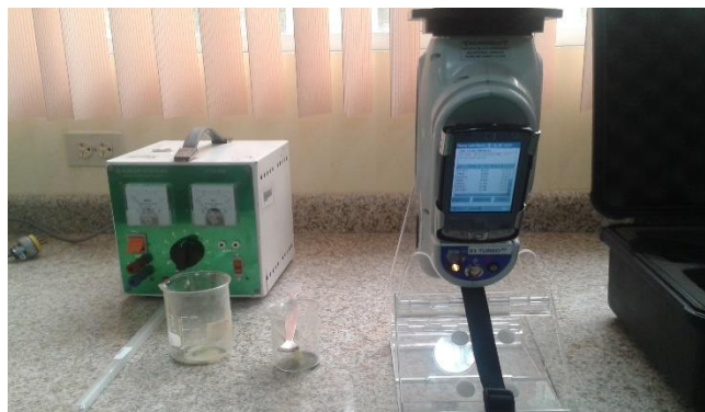
Figura 8. Pistola de Fluorescencia de Rayos X, (FRX).Equipo de la UTPL. Fuente: Flores, A. (2017)
