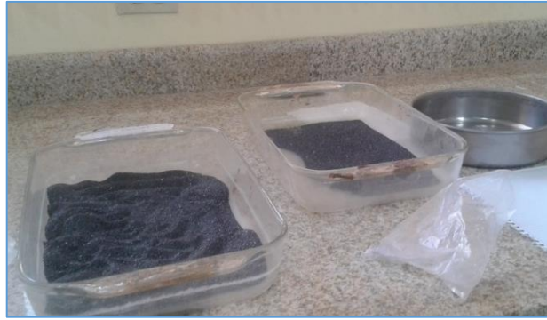
Figura 7. Separación magnética con imán de neodimio. Fuente: Flores, A. (2017)
