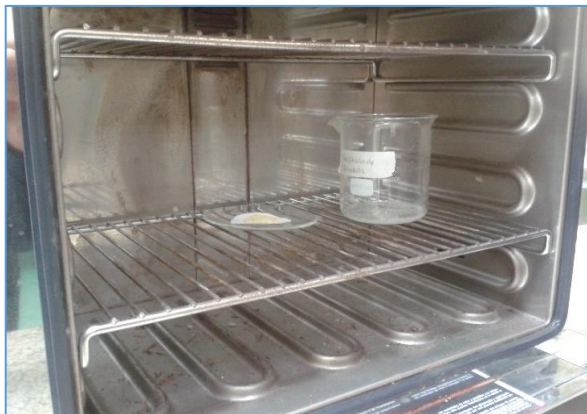
Figura 12. Secado del \text{TiO}_2 precipitado. Fuente: Flores, A. (2017)
