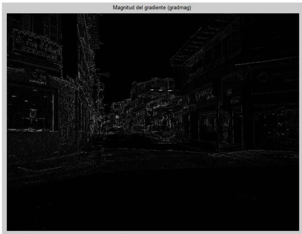
**Figura 31.** Magnitud del gradiente en el algoritmo MAT.
