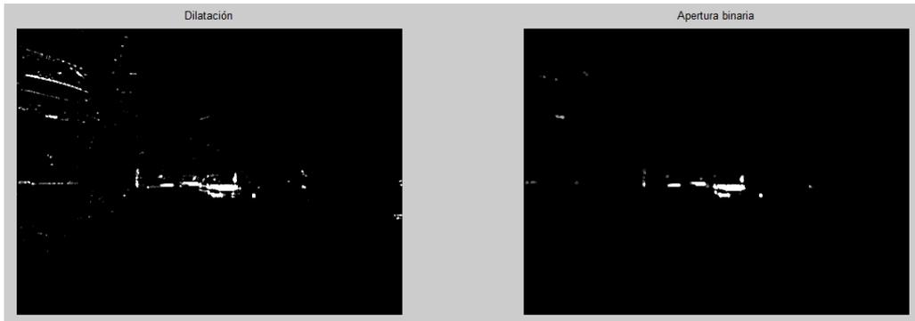
**Figura 8.** Operaciones de dilatación y apertura binaria en el algoritmo propuesto por Zhang (Zhang et al., 2013).
