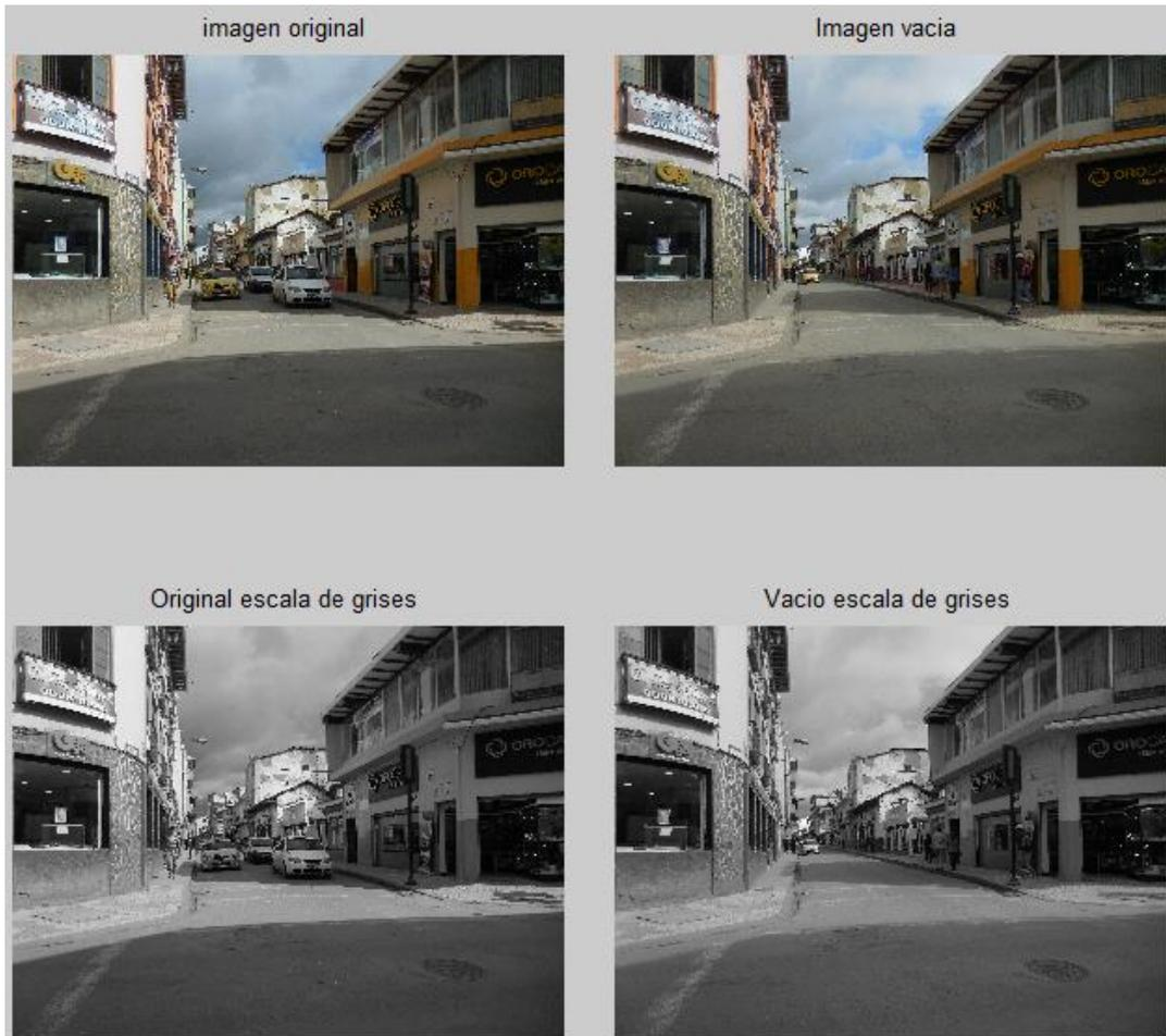
**Figura 18.** Lectura de imágenes y conversión a escala de grises en el algoritmo propuesto por Abinaya (Abinaya et al., 2013).
