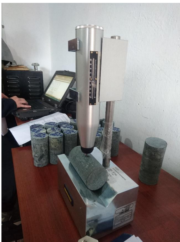
Figura 21. Medición del valor de rebote con martillo Schmidt de bajo impacto
