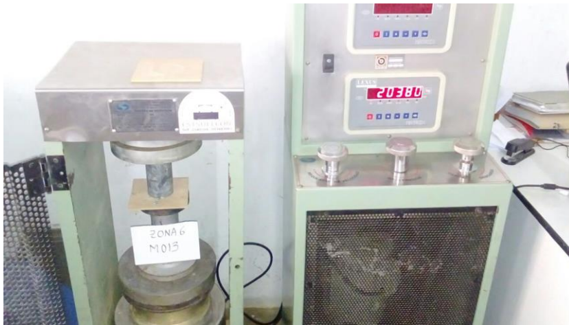
Figura 19. Ensayo de resistencia a la compresión simple en núcleo de zona litoestructural número 6.
