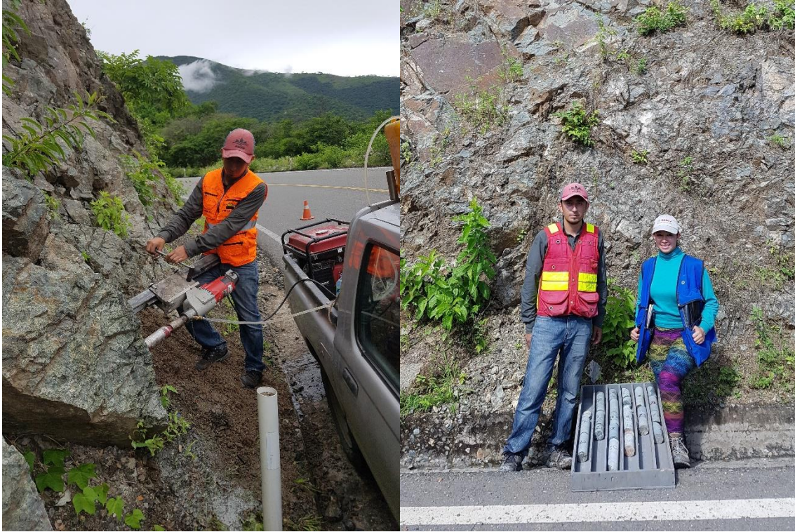
Figura 16. Campaña de Testificación. A la izquierda ejecución de la labor de perforación, a la derecha personal de campo junto al total de muestras extraídas
