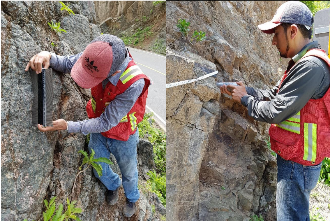
Figura 15. Campaña de Relleno de datos. A la izquierda ejecución de medidas de rugosidad con peine de Barton, a la derecha ejecución de ensayo esclerométrico de bajo impacto.
