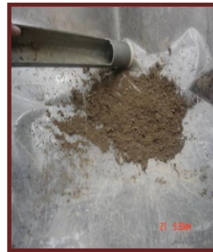
Se coloca las submuestras en un plástico limpio.
