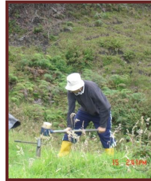
Muestreo de submuestras de profundidad 20 cm.
