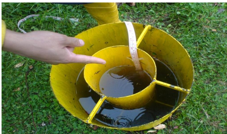
Figura 8. Representación del infiltrómetro sobre el terreno
