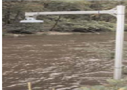
FIGURA 1.6: Sensor RLS OTT colocado en sitio
