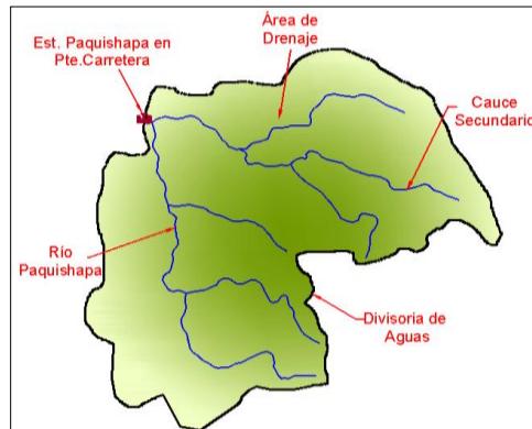
GRÁFICO 5: Cuenca de drenaje al río Paquishapa. FUENTE: EI AUTOR
