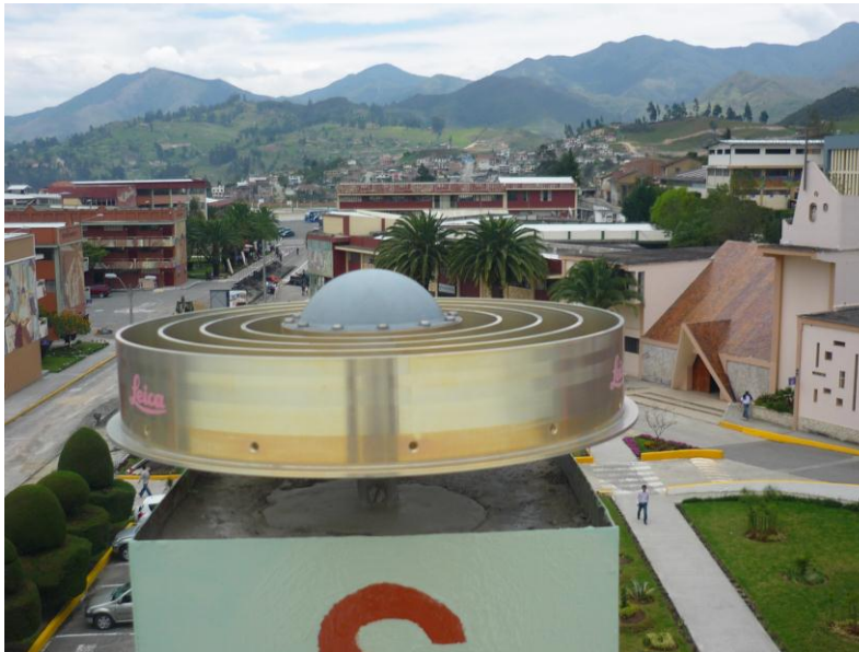
Figura. 4.3. Dispositivo de Centrado Forzoso
