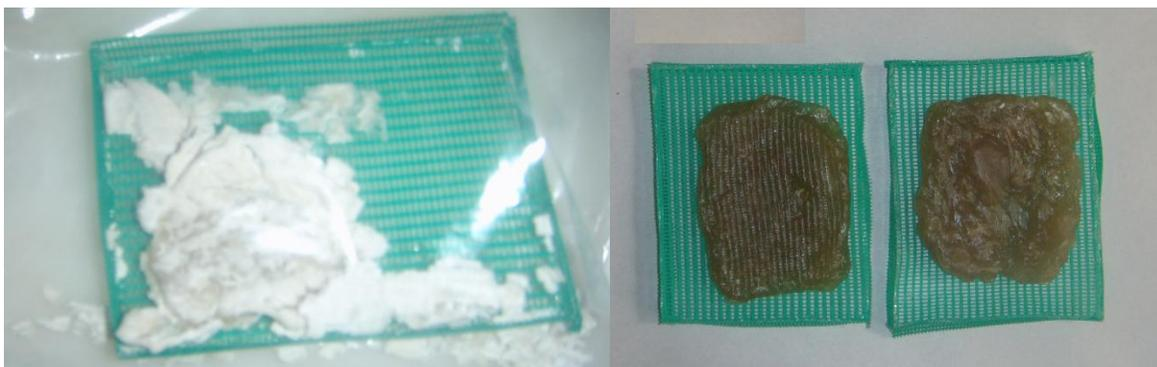
**FIGURA 14.** El proceso de gelatinización no culminó, y la contracción  $<10\text{mm}$  de las muestras durante el secado.
