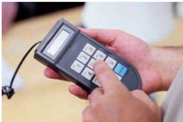
6. Dispositivo que complementa la terminal electrónica y permite ingresar el PIN y completar la transacción. Esta terminal impide que la clave sea visualizada al ser ingresada por el cliente.
