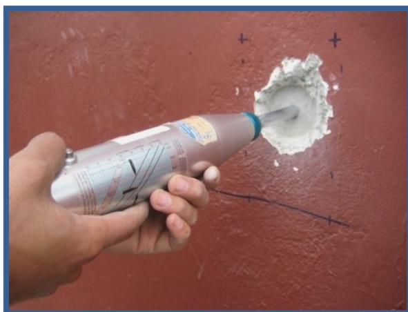
Figura 4-2 Ensayo de esclerometría, "CITTES"
