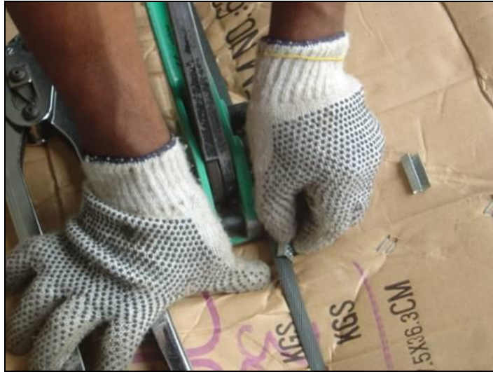
Foto 4. El cartón reciclado es compactado y fijado en bultos de 25 a 35 Kg en el PAFV. Santa Cruz. 2008.
