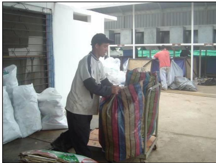
Foto 5. El papel reciclado es compactado y fijado en bultos de 25 a 35 Kg en el PAFV. Santa Cruz. 2008.
