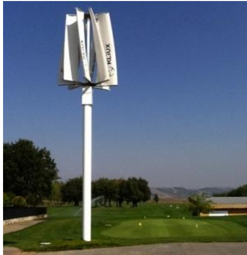
Fig.1. 3 Aerogenerador de eje vertical instalado en El Campus Río Ebro de la Universidad de Zaragoza
