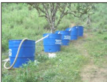
Foto ? 1.- Sistema Cerrado de reutilización de agua en la actividad de perforación de pozos exploratorios
