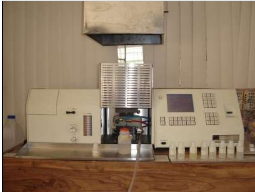
Imagen N° 8: Equipo de absorción atómica momentos cuando se captura una lectura (Foto: El Autor).
