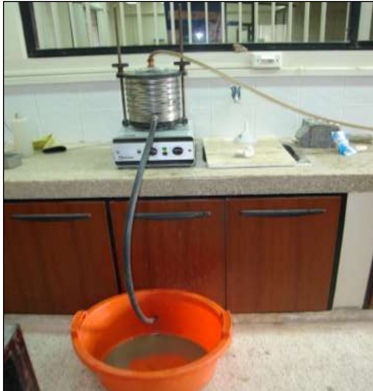
Imagen N° 12: Ensayo Granulométrico de una muestra de relaves en el laboratorio de Beneficio de Minerales (Foto: El Autor).
