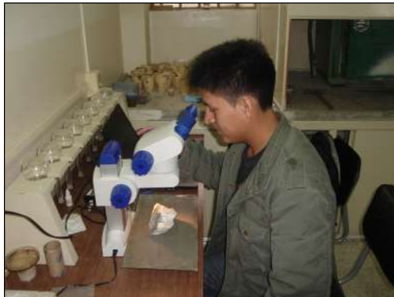
Imagen N° 5: Binocular Estereozoom Stemi DV4, para observación mineralógica de minerales y Rx encajante (Foto: El Autor).
