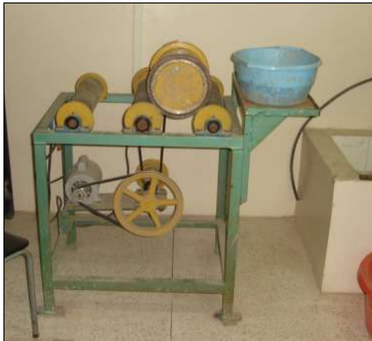
Imagen N° 13: Molino de bolas de laboratorio de beneficio de minerales (Foto: El Autor).
