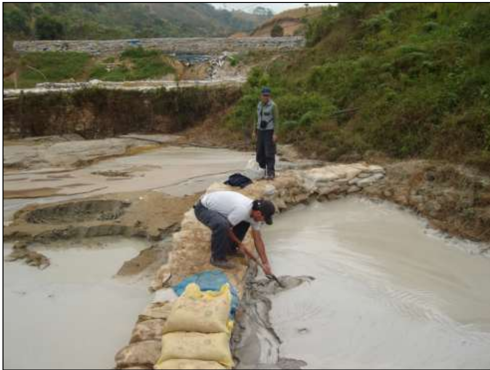
Imagen N° 4: Muestreo de relaves en la planta de beneficio de Expo Bonanza en San Antonio del distrito Minero San Gerardo (Foto: El Autor).
