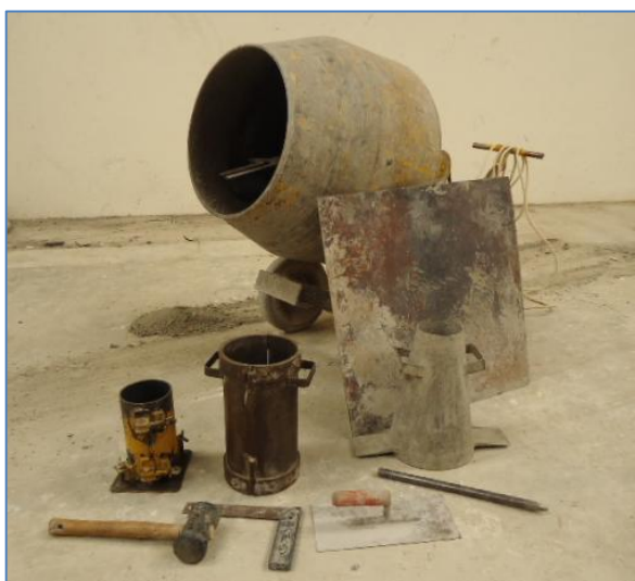
Figura 3-4 Equipo utilizado en la elaboración de especímenes.
