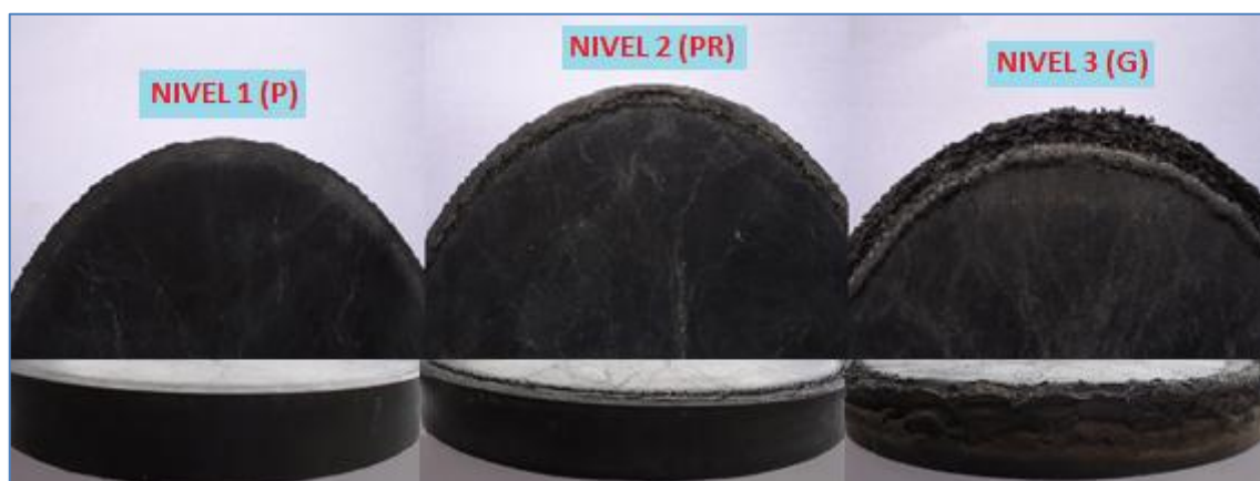
a) Almohadillas para cilindros de 150x300 mm
