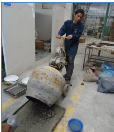
Figura 3-5 Fabricación del hormigón.
