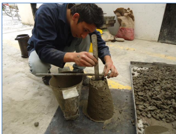
Figura 3-7 Ensayo de asentamiento.
