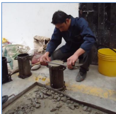
Figura 3-9 Fabricación de probetas.
