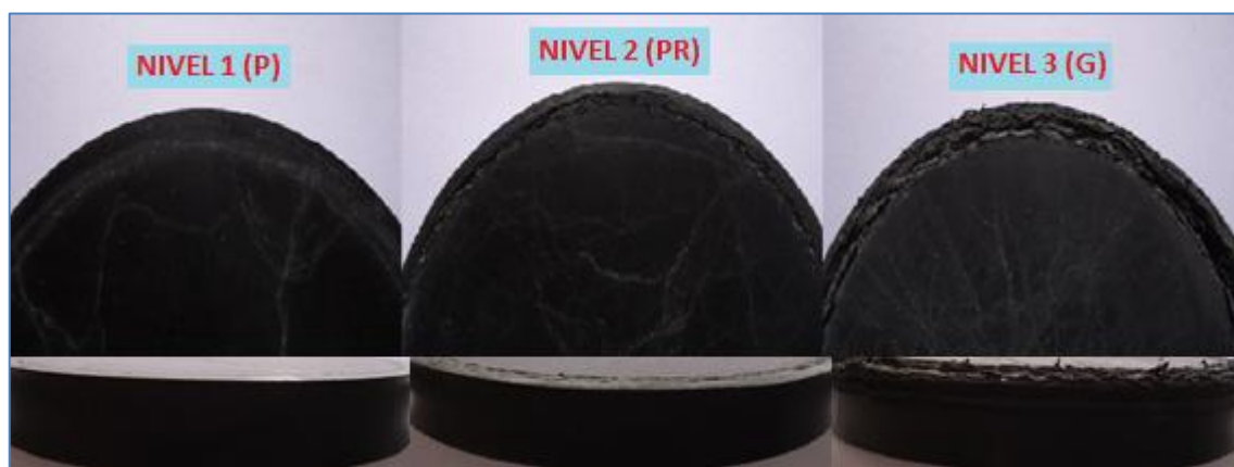
a) Almohadillas para cilindros de 100x200 mm
