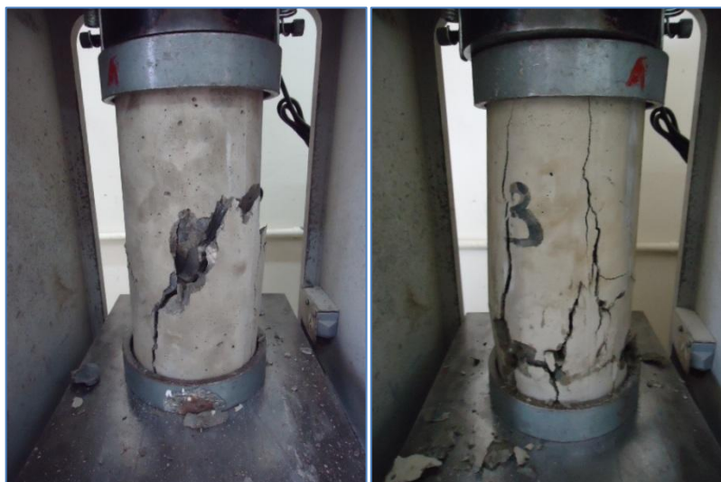
a) Falla tipo 5
