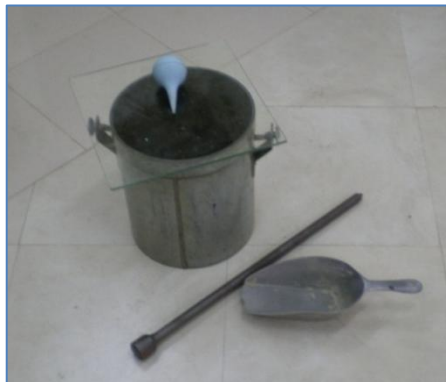
Figura 3-8 Equipo utilizado para determinar la masa volumétrica.
