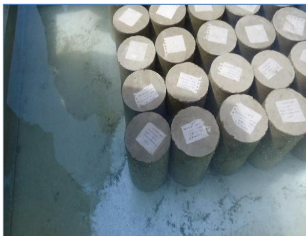
Figura 3-12 Curado de especímenes cilíndricos
