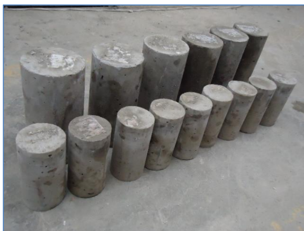
Figura 3-11 Especímenes cilíndricos fabricados
