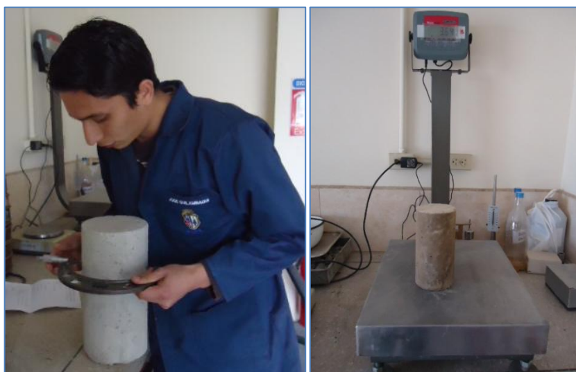
Figura 3-14 Registro de medidas para cada espécimen (Peso, diámetro, longitud)
