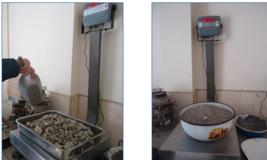
Figura 3-3 Medida de los materiales para el hormigón.
