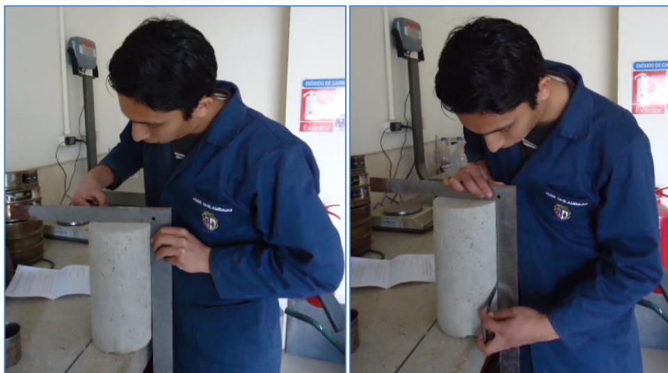
Figura 3-13 Verificación de verticalidad y planeidad de especímenes cilíndricos.
