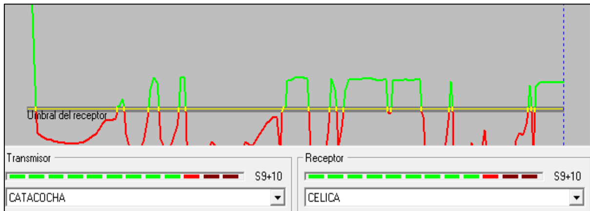
Fig. 3.21. Umbral de recepción, enlace Ciudad de Catacocha – Cerro Pucará. Software: Radio Mobile.
