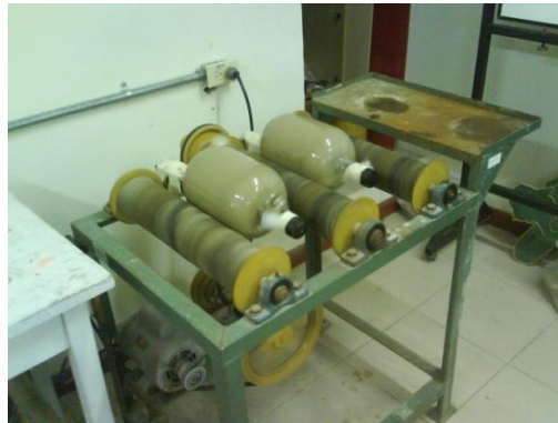
Figura N° 6. Cianuración por agitación en botella (Fuente. Las Autoras)
