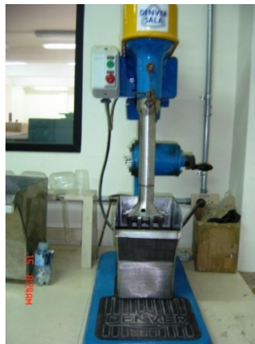
Figura N° 5. Celda de Flotación en el laboratorio PROMEX de la UTPL (Fuente. Las Autoras)
