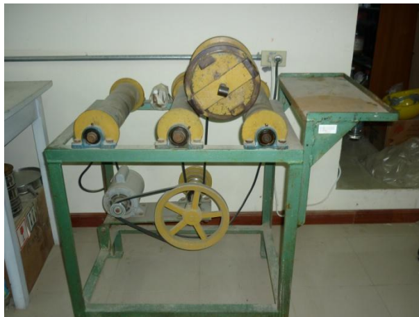
Figura N° 4. Molino de bolas, en el laboratorio PROMEX de la UTPL (Fuente. Las Autoras)
