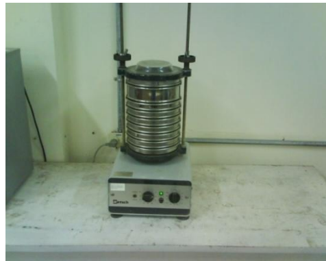
Figura N° 3. Análisis Granulométrico en el laboratorio PROMEX de la UTPL. (Fuente, Las Autoras)
