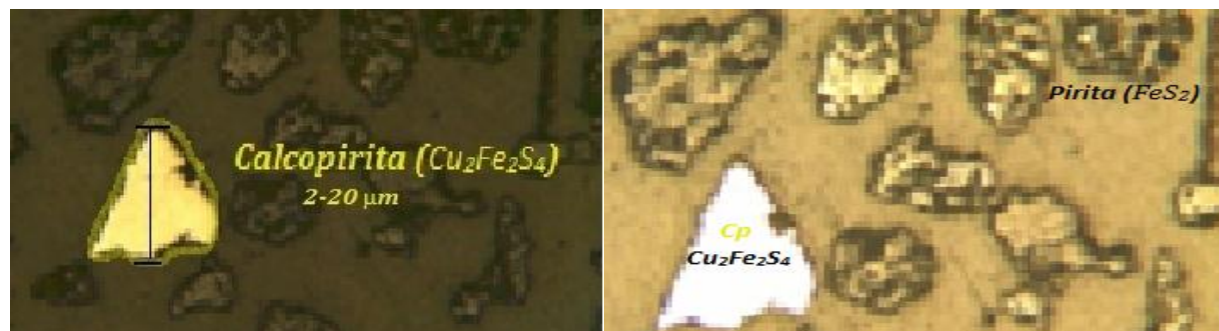
Fig. 3.2 Minerales metálicos calcopirita y pirita vistos con polizador y sin polizador respectivamente.
