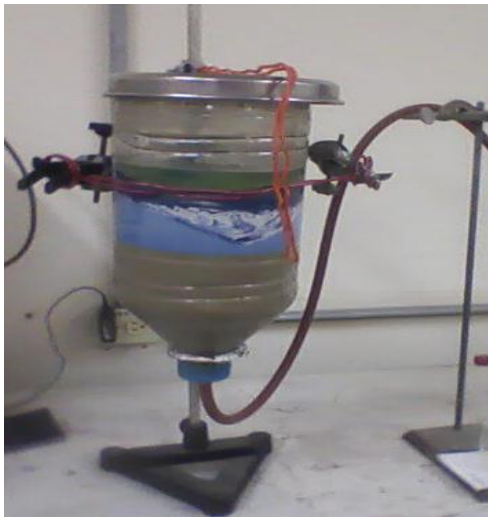
Fig. 2.2 Agitador neumático. Fuente: La Autora
