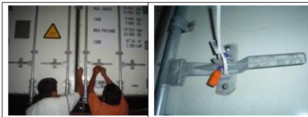
Foto 18 y 19.- Colocación de los sellos de seguridad en el contenedor
