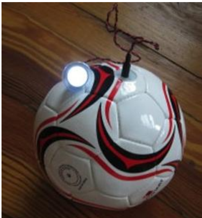
Fig. 2. 3 Sistema de iluminación basada en el sOcket
