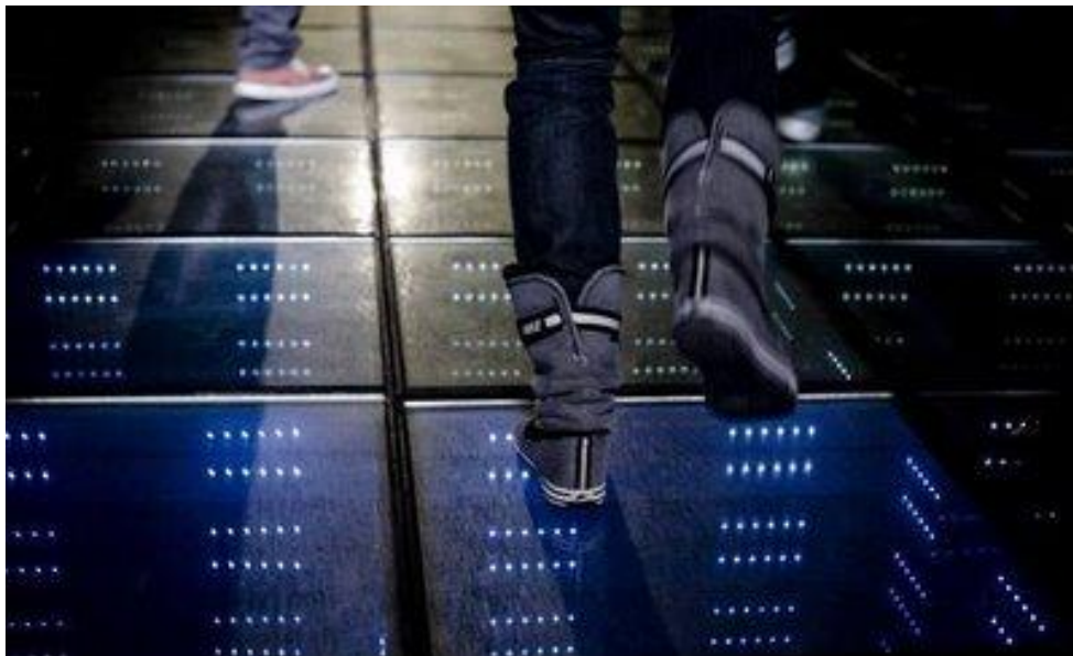
Fig. 1. 8 Pista de baile energizada por materiales piezoeléctricos
