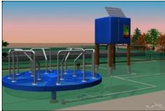
Fig. 2. 12 Equipo para generar energía eléctrica de Water Power Peace Project
