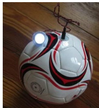
Fig. 1. Sistema de iluminación basada en el sOcket
