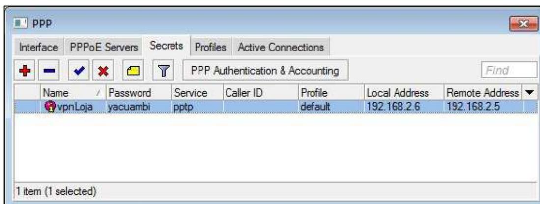
Fig. A.7 Conexión VPN configurada, vía Winbox. Elaborado por los autores.
