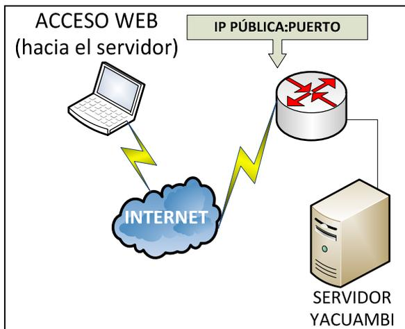
Figura 2. Acceso al servidor mediante IP pública
