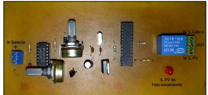
Fig. 12. Módulo de conmutación construido para este proyecto. [Autores]
