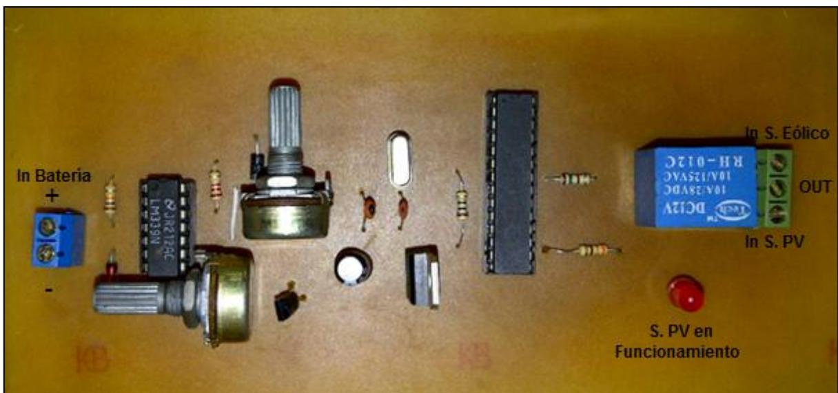
Fig. 4.7 Módulo de conmutación construido para este proyecto.
