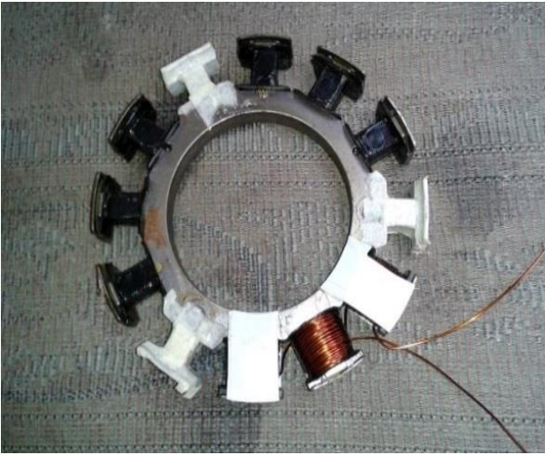
a. Embobinado del estator del magneto.
