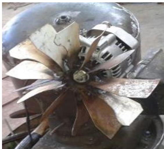
Figura 2.9. Adaptación de una turbina propulsada por aire a un alternador de automóvil para la generación de energía eléctrica en el sistema a implementar. Diseño de los autores.
