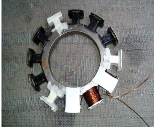
a. Embobinado del estator del magneto.
