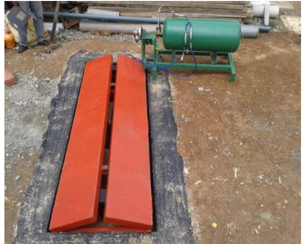
Fig. 25. Vista general del sistema de harvesting d energía para accesos vehiculares instalado. Fotografía de los autores.
