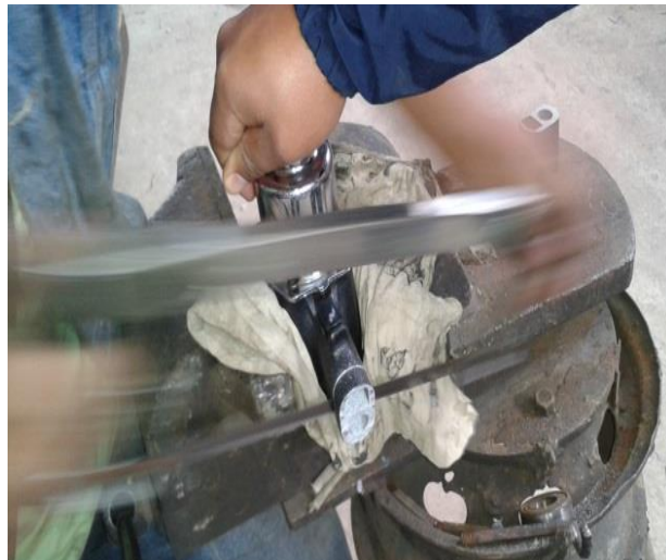
a. Corte del mango de la pistola para poder extraer el mecanismo de accionamiento.
