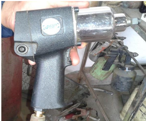
Fig. 12. Pistola neumática de impacto a ser modificada para adaptarla al sistema. Fotografía de los autores.
