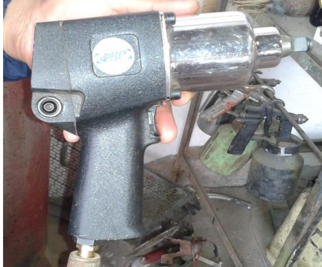
Figura 3.12. Pistola neumática de impacto a ser modificada para adaptarla al sistema. Fotografía de los autores.
