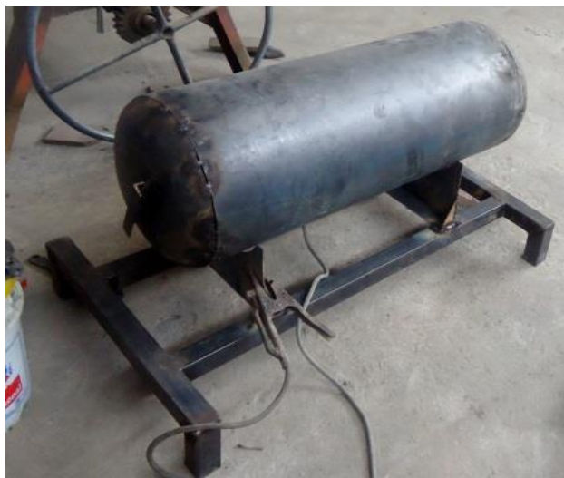
d. Tanque colocado sobre el soporte.
