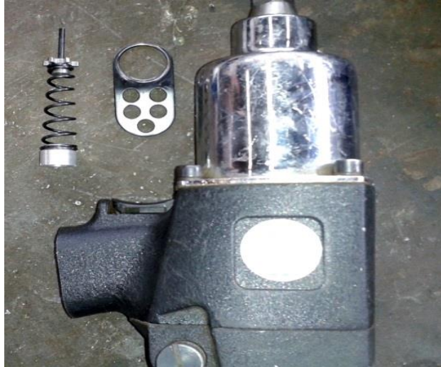
b. Extracción del mecanismo de activación de la pistola neumática.
