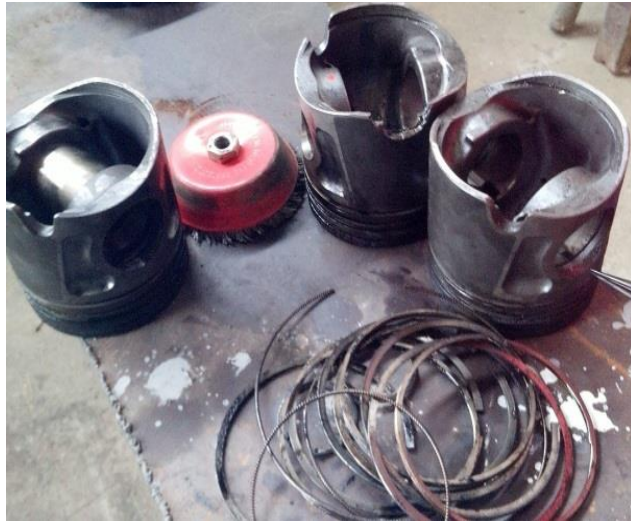
Figura 3.6. Pistones reciclados del motor de un vehículo pesado. Fotografía de los autores.
