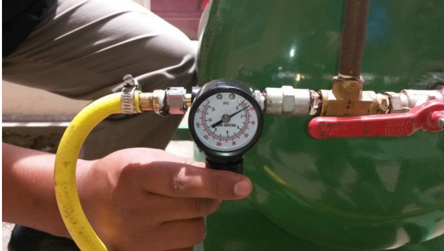
Figura 4.5. Regulación de la presión de alimentación de la pistola neumática. Fotografía de los autores.
