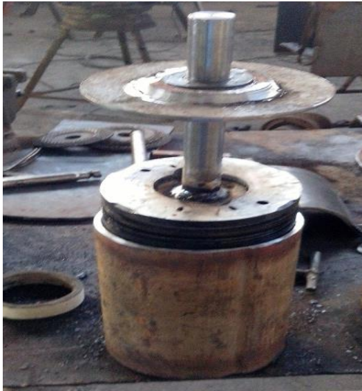
b. Colocación del pistón en las camisa, y sellado de los cilindros.
