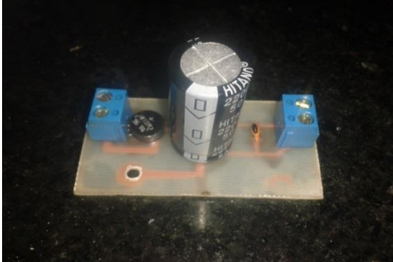
Fig. 35. Circuito rectificador implementado. Fotografía de los autores
