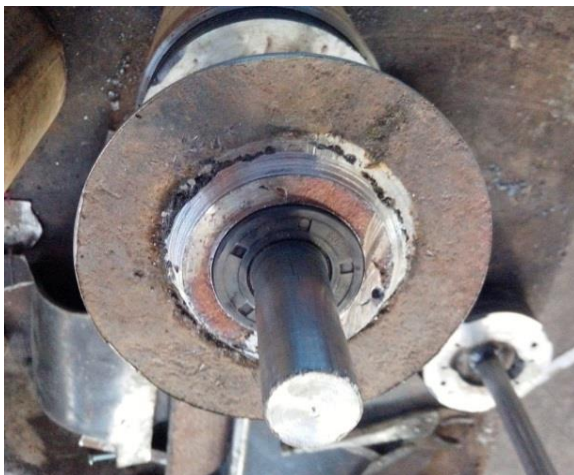
c. Instalación de los retenes en las tapas de los cilindros.
