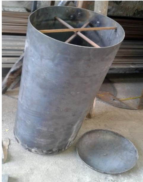
c. Proceso de ensamblaje del tanque.
