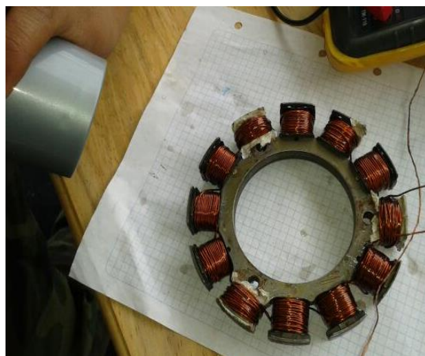
c. Secado de la resina en las bobinas una vez terminado el proceso de embobinado.
