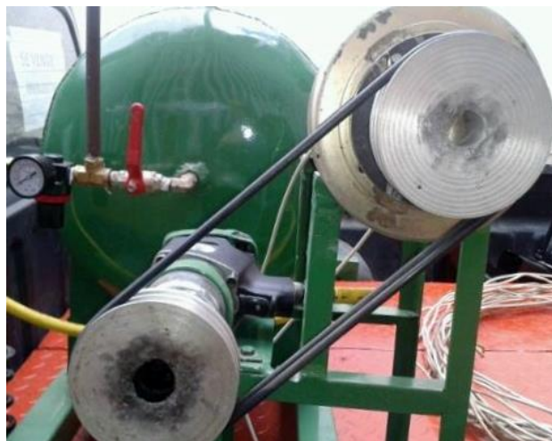
Figura 3.14. Sistema de transmisión 1:1, conformado por poleas, para la transferencia de energía desde el rotor de la pistola hacia el generador. Fotografía de los autores.
