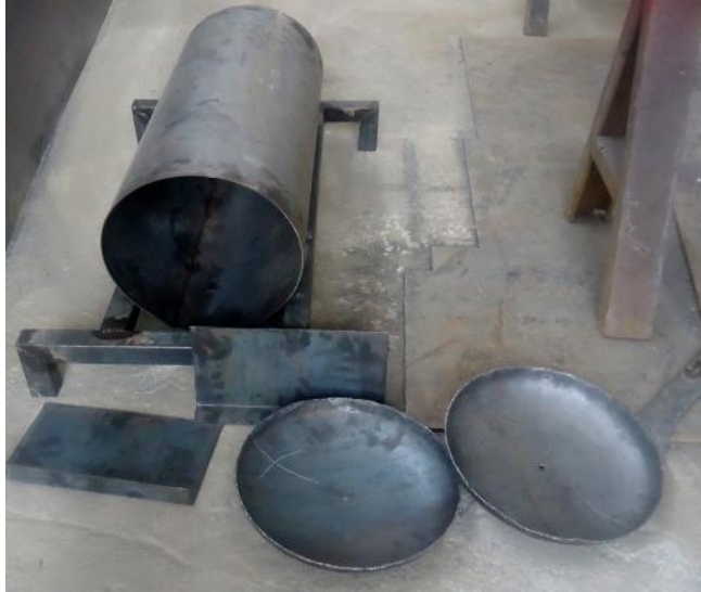
b. Construcción de partes del tanque para su posterior ensamblaje.
