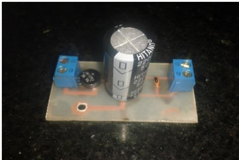
Figura 4.10. Circuito rectificador implementado. Fotografía de los autores
