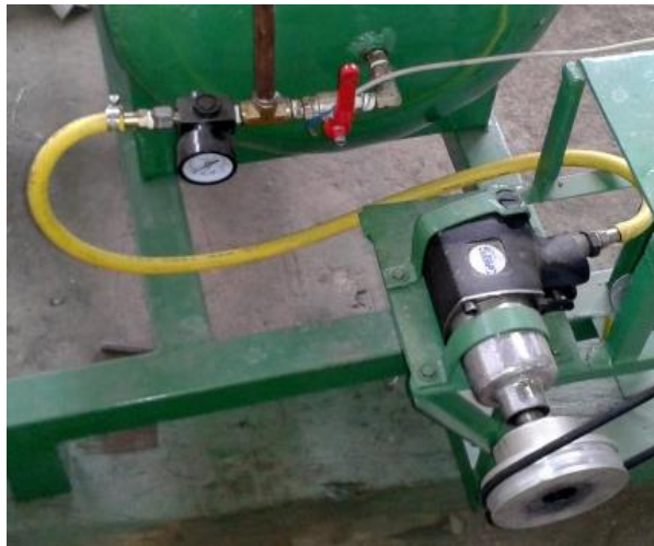
c. Adaptación de la pistola neumática modificada al tanque compresor.
