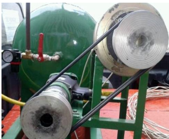
Fig. 14. Sistema de transmisión 1:1, conformado por poleas, para la transferencia de energía desde el rotor de la pistola hacia el generador. Fotografía de los autores.
