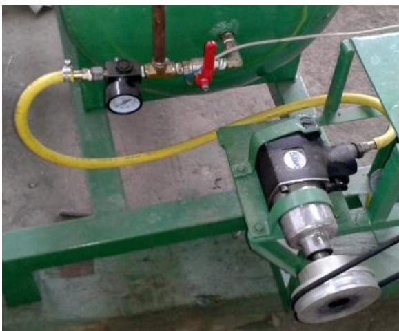
Fig. 13. Adaptación de la pistola neumática modificada al tanque compresor. Fotografías de los autores.
