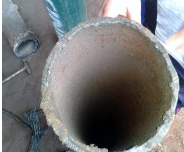
Figura 3.5. Camisa de tubo de gato hidráulico reciclado. Fotografía de los autores.
