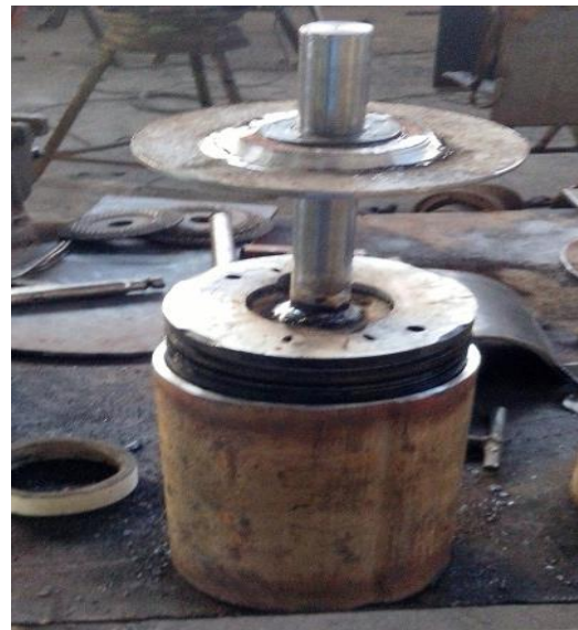
a. Colocación del pistón en las camisa, y sellado de los cilindros.
