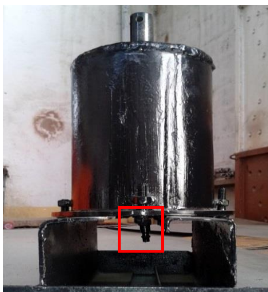
d. Colocación de las válvulas de entrada y salida de aire.
