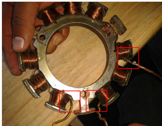
Figura 3.16. Estator del magneto con embobinado en conexión tipo estrella. Fotografía de los autores.
