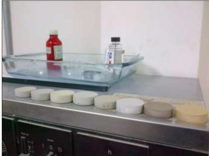
Muestras de arcillas sometidas a saturación para el ensayo de límite líquido y límite plástico.
