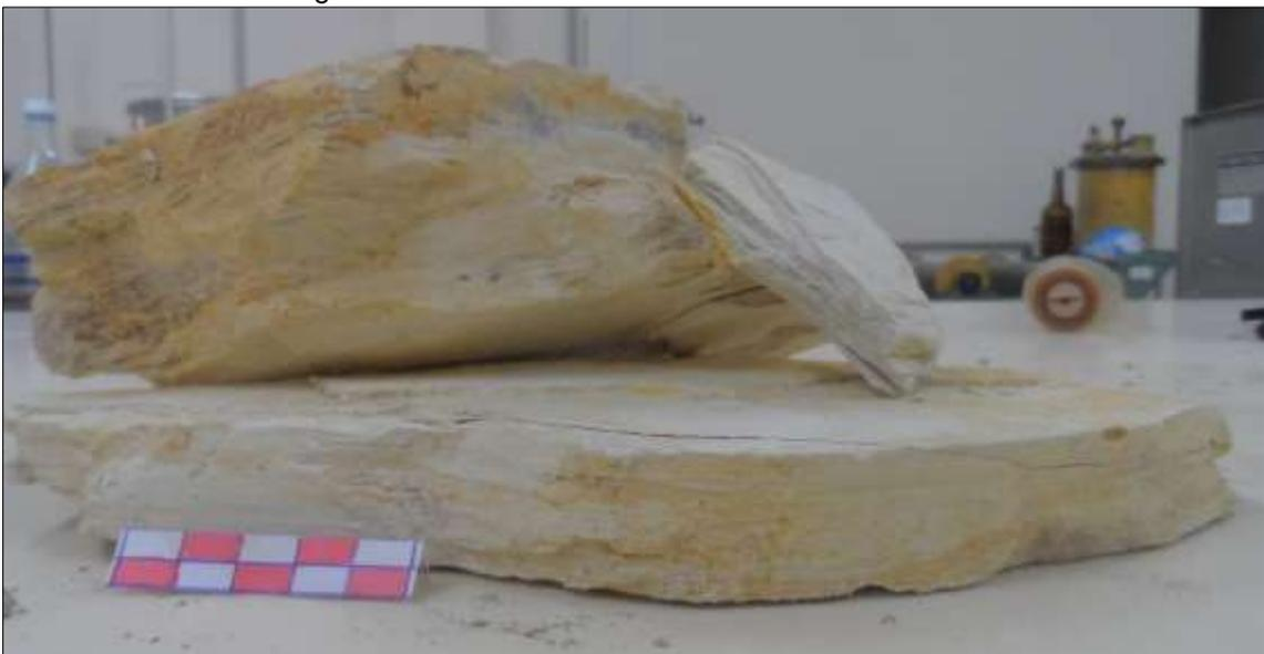
Muestra P6-M1. Arcillas masivas con tinte naranja por la presencia de oxidaciones
