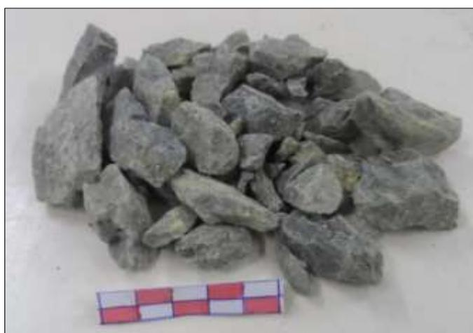
Fig. 17 Lutitas pertenecientes al afloramiento del Punto 1, muestra P1-M1. Fuente y elaboración: Autor
