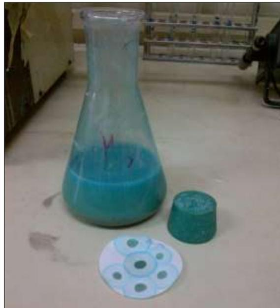
Realización del ensayo de absorción de azul de metileno.
