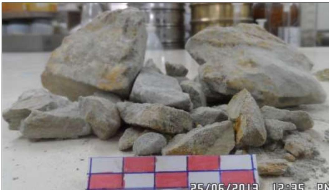
Fig. 21 Limolitas aflorantes en el Punto 2, muestra P2-M1. Fuente y elaboración: Autor
