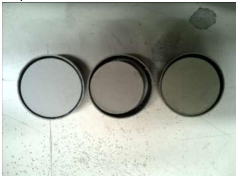
Muestras disueltas en agua destilada, antes del ensayo de absorción de azul de metileno.
