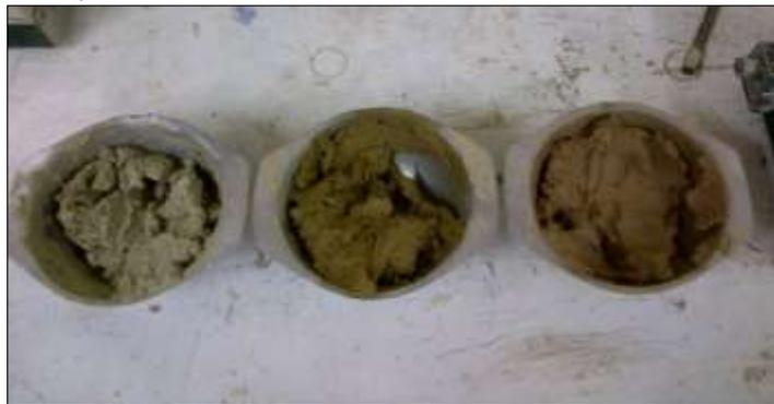
Ensayo del límite de retracción.
