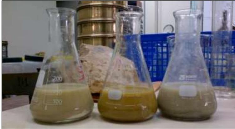
Muestras disueltas en agua destilada, después de finalizado el ensayo de absorción de azul de metileno.
