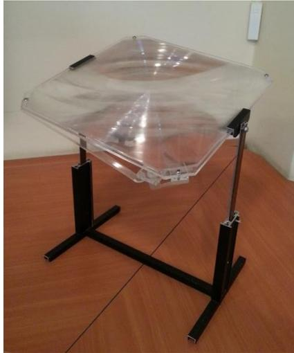
Figura 4.2. Concentrador solar diseñado y construido.
