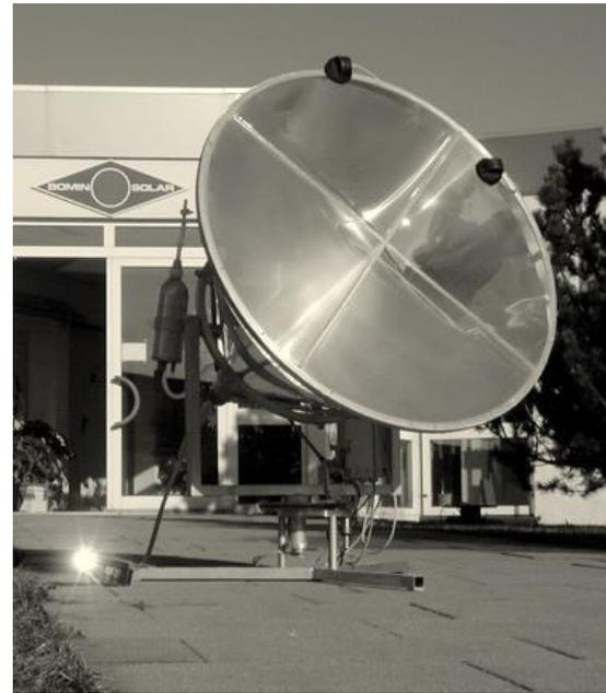
**Fig. 2.** Sistema de transporte de luz natural con colector de Fresnel y tubo líquido de luz.
