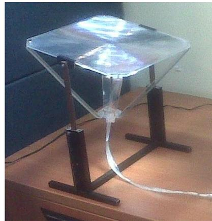
**Fig 13.** Experimento de propagación de luz en fibra óptica suelta. Fotografía de los autores
