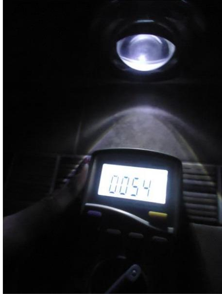
Figura 3.11. Medición de la potencia luminosa del prototipo optimizado.
