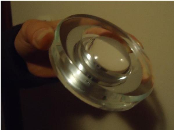
**Fig.12.** Difusor diseñado y construido. Fotografía de los autores.
