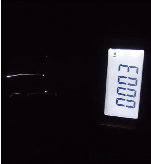
Figura 3.7. Medición de la potencia luminosa del prototipo C.
