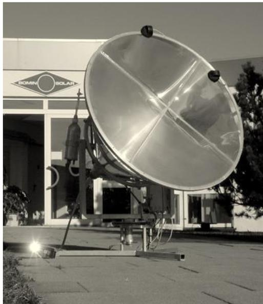
Figura 1.3. Sistema de transporte de luz natural con colector de Fresnel y tubo líquido de luz.
