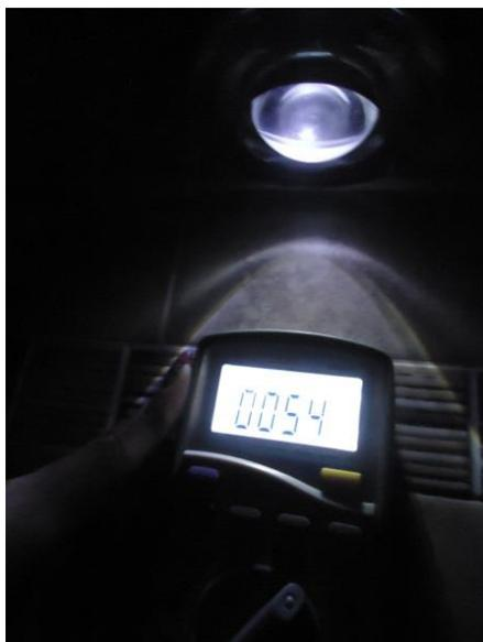
**Fig. 9.** Medición de la potencia luminosa del prototipo optimizado.
