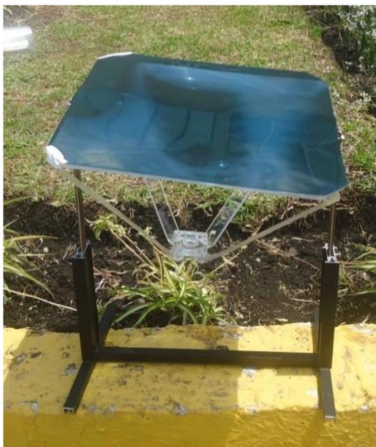
Figura 4.9. Uso de película radiográfica sobre el concentrador solar.
