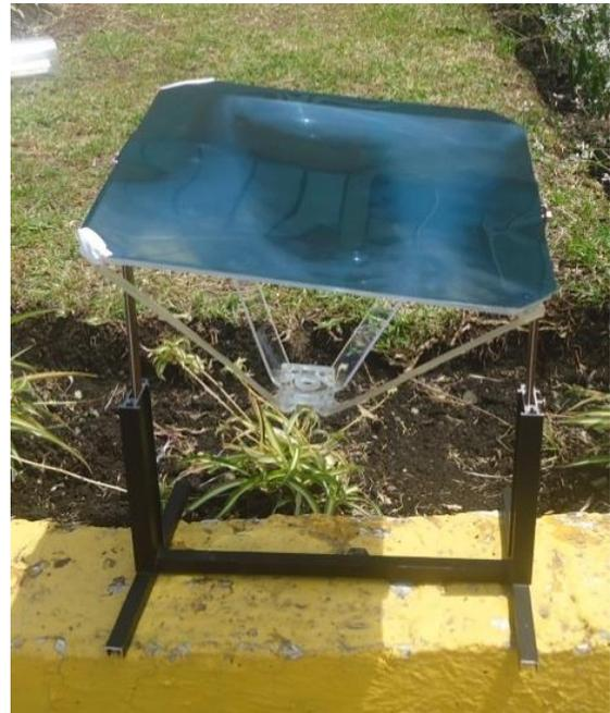
Fig.17. Uso de película radiográfica sobre el concentrador solar. Fotografía de los autores.
