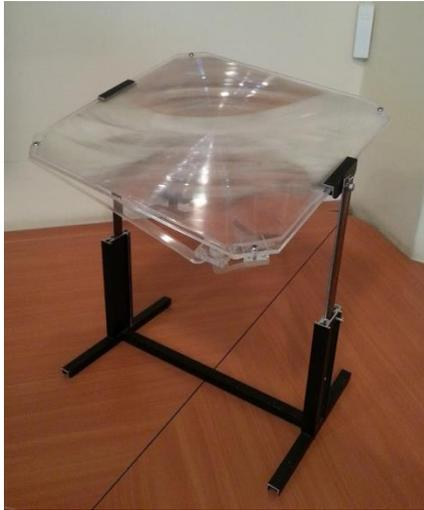
**Fig.11.** Concentrador solar diseñado y construido. Fotografía de los autores.
