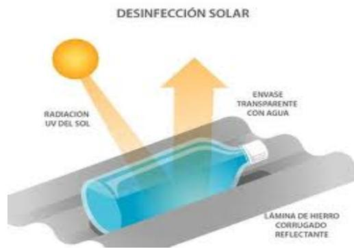
**Fig. 1.3.** Desinfección de agua por rayos solares
