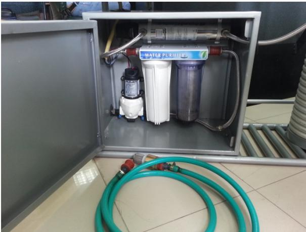
**Fig.16** Montaje de los componentes del módulo de tratamiento en la caja metálica. Fotografía de autores.
