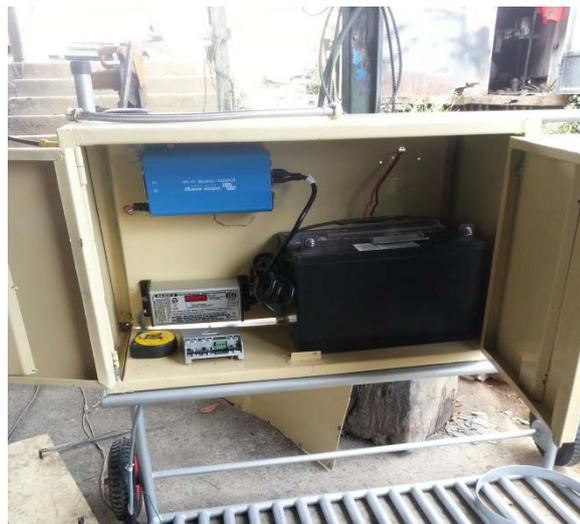
**Fig. 3.17.** Montaje de los componentes del módulo de Control.
