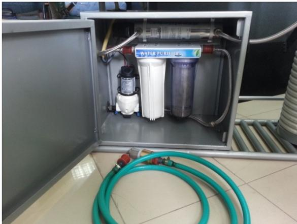
**Fig. 3.19.** Montaje final del módulo de tratamiento.
