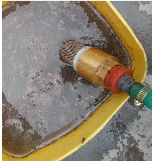
**Fig. 3.22.** Filtro de la manguera de captación.
