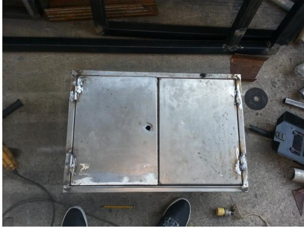
**Fig. 3.14.** Construcción de las cajas metálicas.
