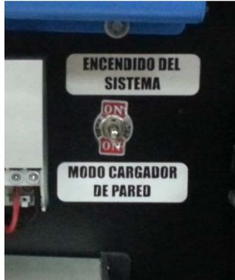
**Fig. 4.1.** Interruptor principal del sistema.
