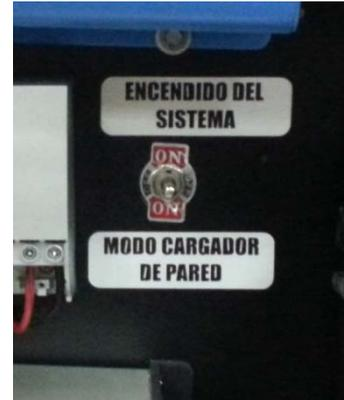
Fig.19. Interruptor principal del sistema. Fotografía de autores.
