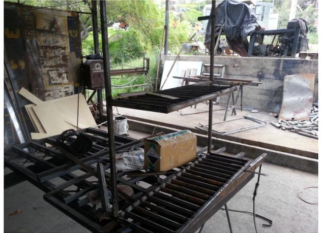
**Fig.17** Construcción del armazón metálico para soportar al sistema. Fotografía de autores.
