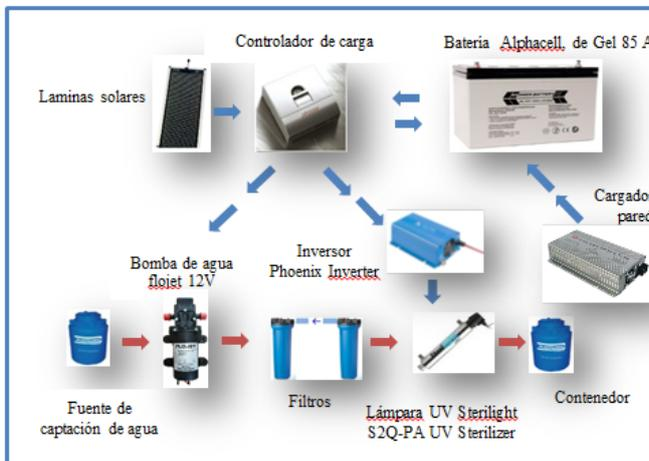
Fig.10 Diagrama de flujo eléctrico e hidráulico del sistema a implementar. Elaboración de autores.
