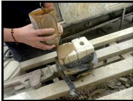
Figura 32. Vertimiento de la barbotina en los moldes
