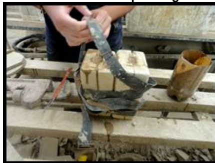
Figura 35. Quitar los cauchos que aseguran los moldes
