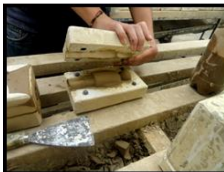
Figura 38. Retirando la primera cara del molde
