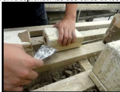
Figura 37. Desprender las dos caras de los moldes
