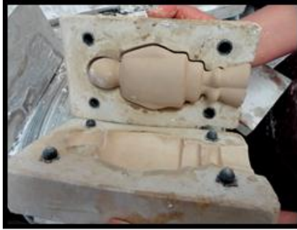
Figura 31. Segunda cara del molde
