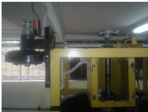
Figura 5.11 Instalación del encoder HC-020K en la chumacera de la transmisión mecánica.
