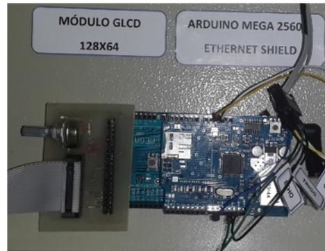
**Fig. 17** Acoplamiento de la pantalla a la placa Arduino. Fotografía de los autores
