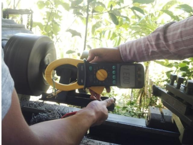
Figura 2.6 Medición de corriente que soporta el generador eléctrico
