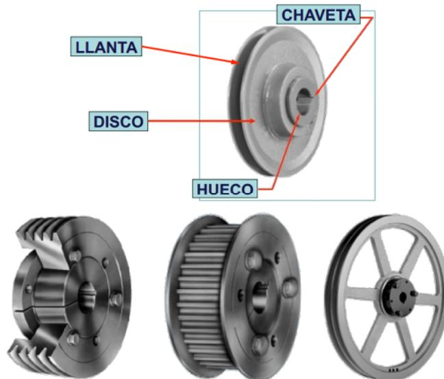
Figura 2.3 Partes y tipos de poleas.
