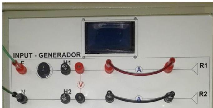
Figura 6.1 Bornes de conexión de voltaje AC generado por el GAM-FD en el tablero del panel de control.
