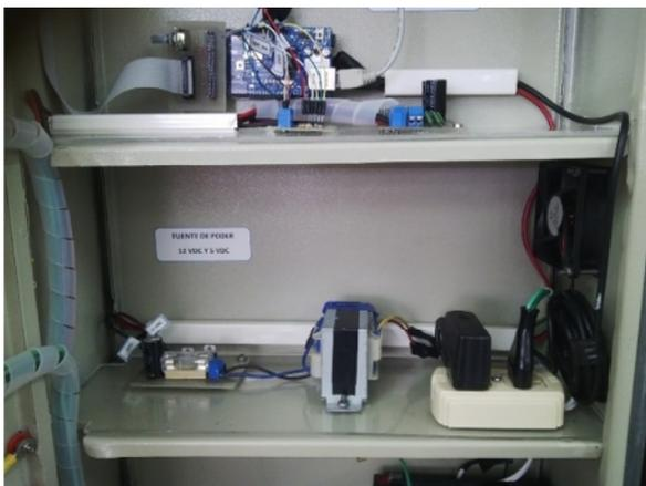
Fig. 6 Sección de climatización y alimentación de energía eléctrica a la sección de módulo de monitoreo. Fotografía de los autores.
