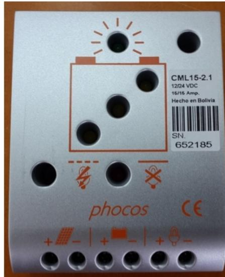
Figura 3.14 Regulador de voltaje CML15-2.1.
