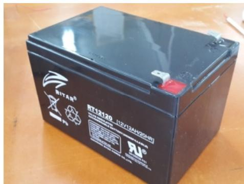
Figura 3.10 Batería VRLA de 12V y 12AH.
