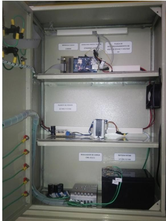
Figura 5.9 Esquema eléctrico de conexiones internas en el panel de control.
