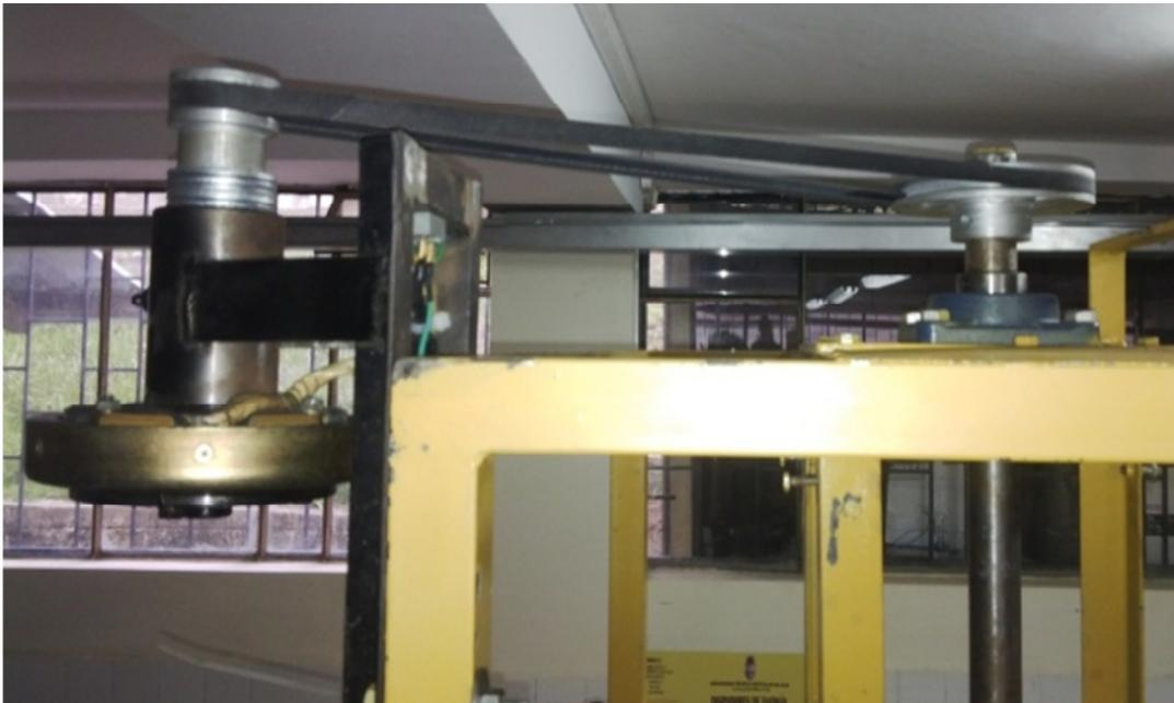
Figura 3.6 Bloque de generación eléctrica instalado en el banco hidráulico.
