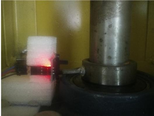
**Fig. 13**Detalle de la instalación del encoder HC-020K en la chumacera de la transmisión mecánica. Fotografía de los autores.
