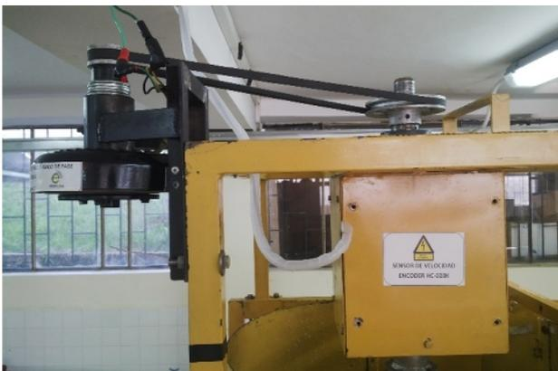
Fig. 3 Bloque de generación eléctrica instalado en el banco hidráulico. Fotografía de los autores.
