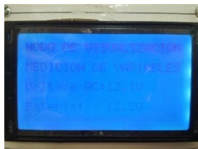
**Fig. 18** Nodo de visualización en operación. Fotografía de los autores
