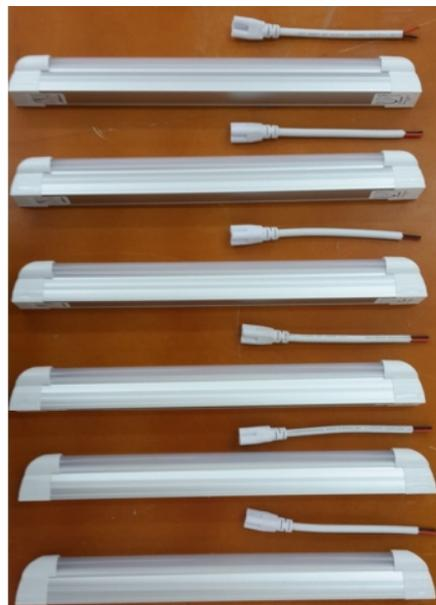
Figura 3.15 Lámparas LED a utilizar como carga resistiva para evaluación del desempeño del bloque de generación.
