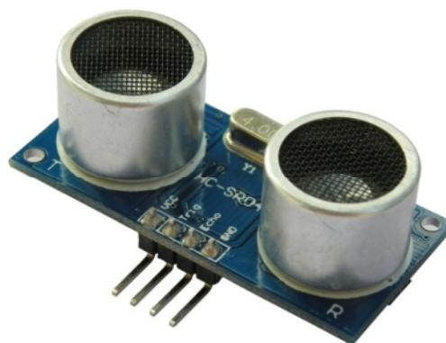
Figura 4.6 Vista general del sensor ultrasónico HC-SR04
