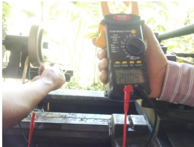
Figura 2.5 Medición de voltaje en los bornes del generador eléctrico
