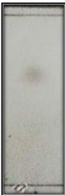
**Figura 18:** Cromatograma revelada de las fracciones DF14, fase estacionaria: sílica gel, y fase móvil Hex-AcOEt 7:3.
