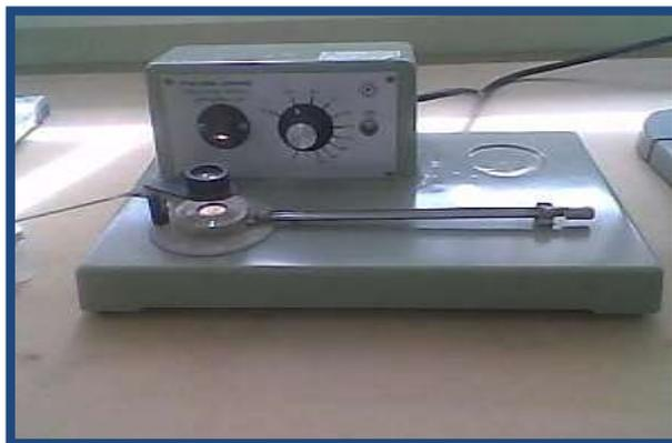
**Figura 9:** Equipo de fusión Fisher-Johns-Melting Point Apparatus serial 40-22.
