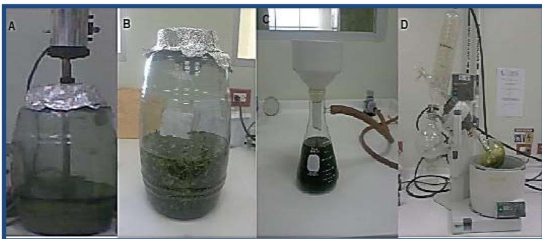
**Figura 5:** Obtención de los extractos. a. Maceración dinámica (5min), b. Maceración estática (55min), c. Filtración al vacío, d. Rota evaporación.
