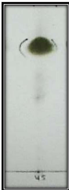
**Figura 12:** Cromatograma revelado de la fracción DF5. Fase estacionaria: sílica gel directa y fase móvil: Hex- AcOEt 7:3
