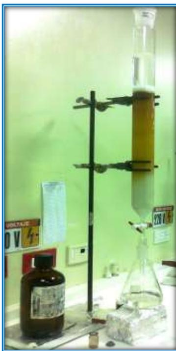
**Figura 8:** Cromatografía en columna del extracto DL1.1.
