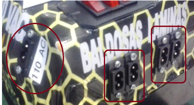
Figura 4.1 Bahías para la conexión del módulo a láminas solares y baldosas piezoeléctricas. Fuente: fotografía de los autores.
