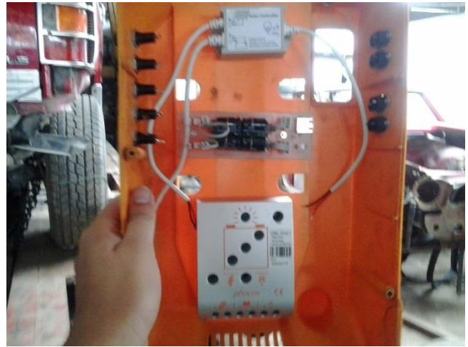
Fig. 8. Ubicación de controladores de carga y del cosechador en el cuerpo del equipo reutilizado. Fotografía de los autores
