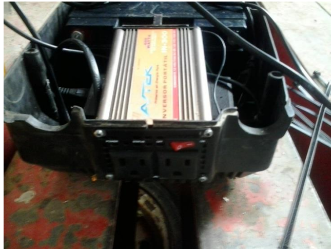
Figura 3.11 Ubicación de la interface del inversor en el cuerpo.
