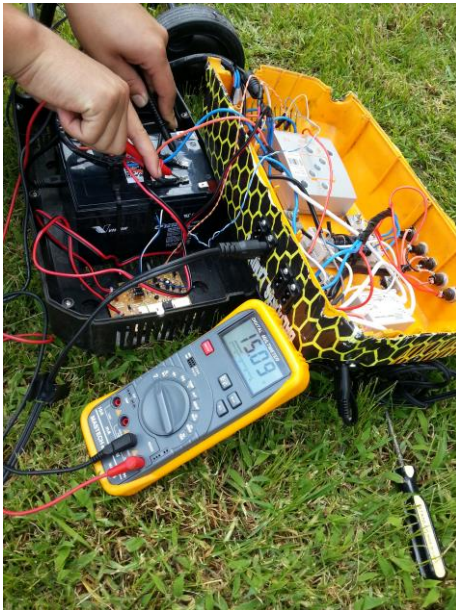
Fig. 19. Prueba de carga del módulo desde una lámina solar. Fotografía de los autores.
