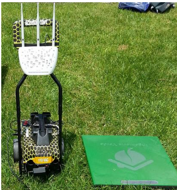
Fig. 20. Prueba de carga del módulo desde una baldosa piezoeléctrica. Fotografía de los autores
