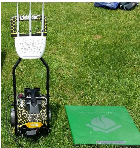
Figura 4.6 Prueba de carga del módulo desde una baldosa piezoeléctrica. Fuente: fotografía de los autores.
