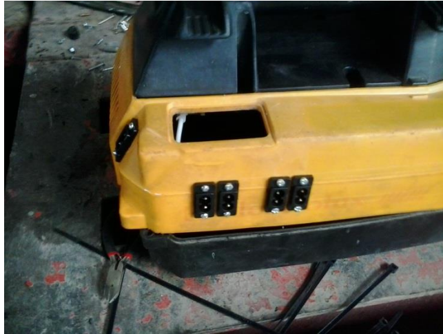
Figura 3.9 Ubicación de las bahías en el exterior del cuerpo. Fuente: fotografía de los autores.
