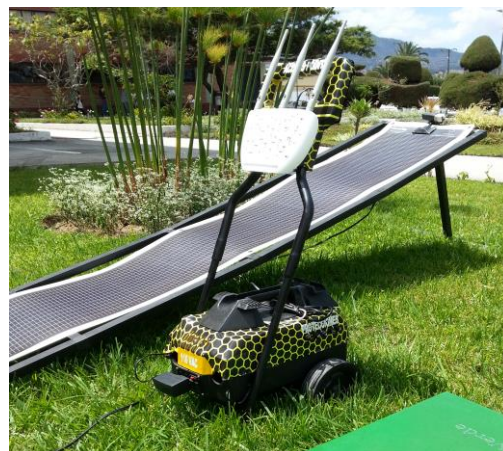
Fig. 14. Módulo de provisión de energía con todos los componentes acoplados Fotografía de los autores
