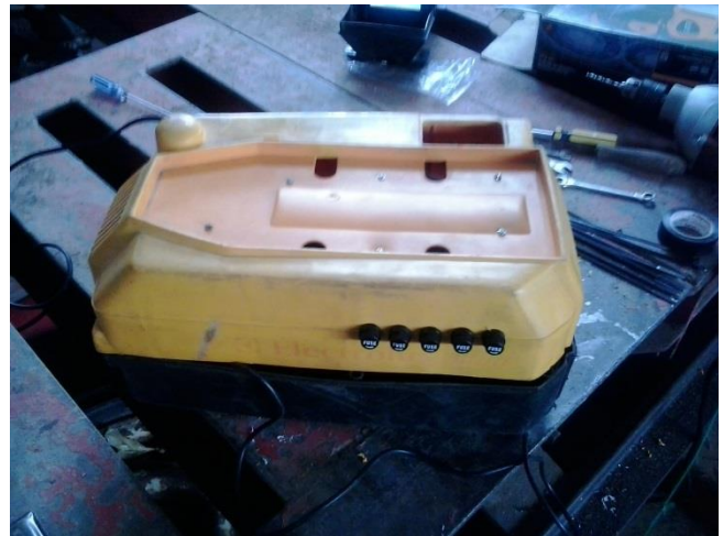
Fig. 9. Ubicación de las protecciones en el exterior del cuerpo. Fotografía de los autores
