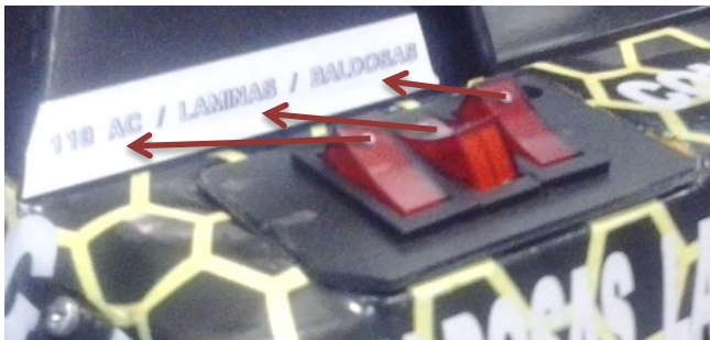
Fig. 16. Selección de la fuente de alimentación al módulo. Fotografía de los autores
