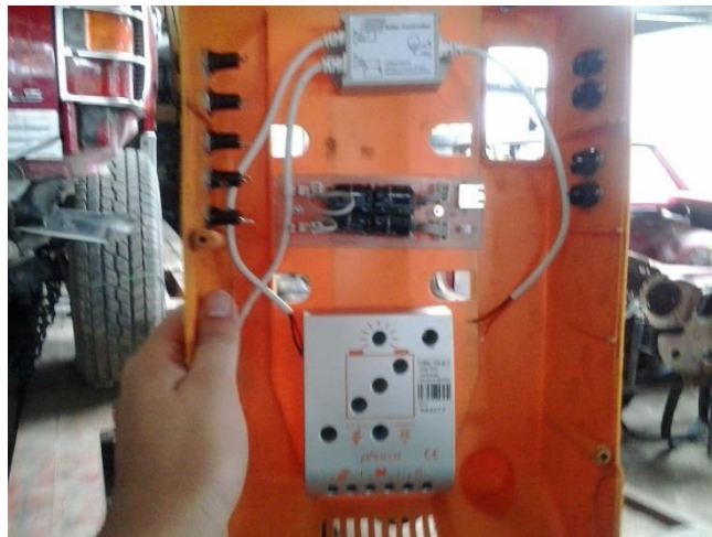
Figura 3.7 Ubicación de controladores de carga y del cosechador en el cuerpo del equipo reutilizado. Fuente: fotografía de los autores.
