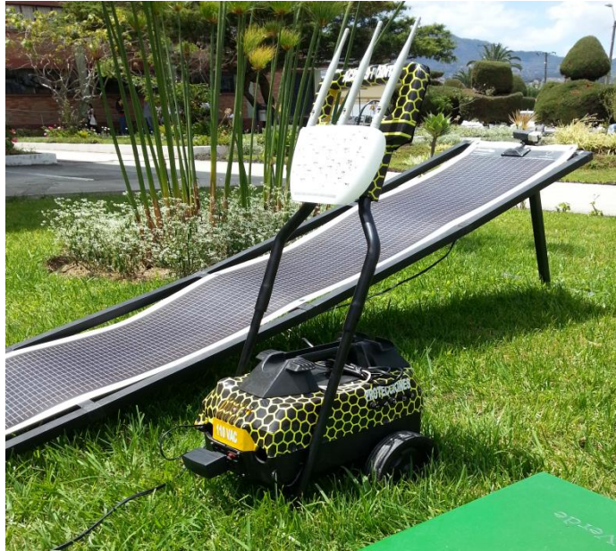
Figura 3.13 Módulo de provisión de energía con todos sus componentes acoplados. Fuente: fotografía de los autores.
