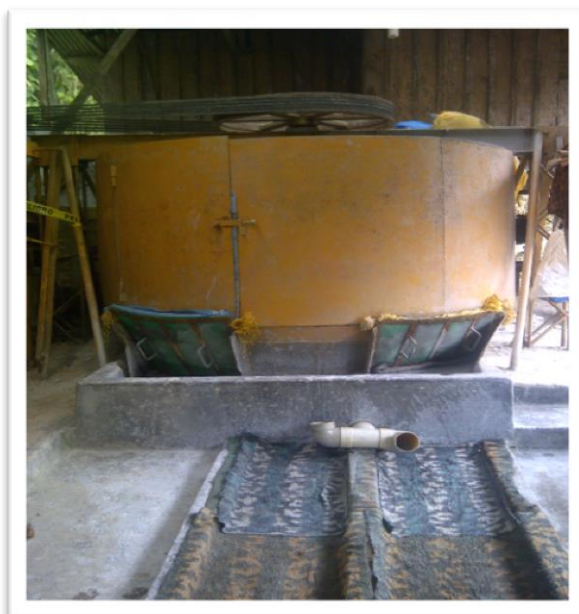
Imagen 7 (Molino Chileno y Canalones)
