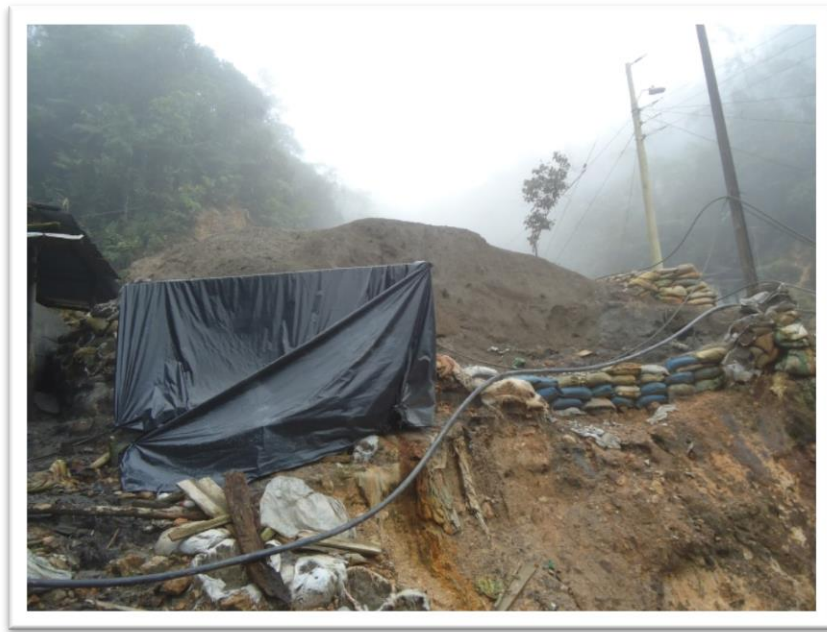
Imagen 18 (Distintos materiales en escombrera, tanto relaves o colas, como roca estéril)
