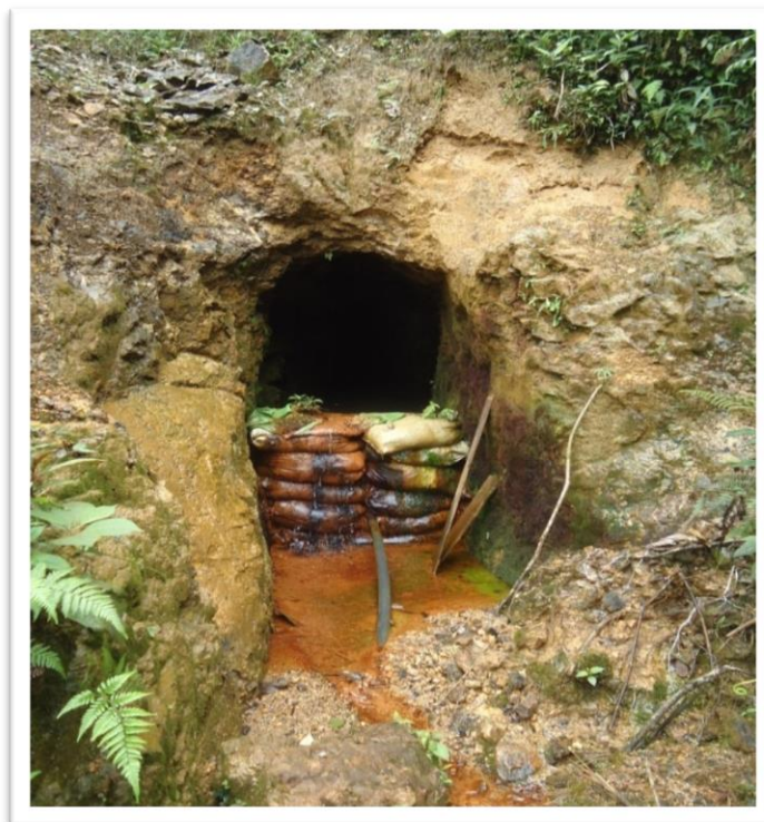
Imagen 37 (Aguas ácidas, producto de la exposición de minerales como la pirita, la galena y la esfalerita, al oxígeno y agua)
