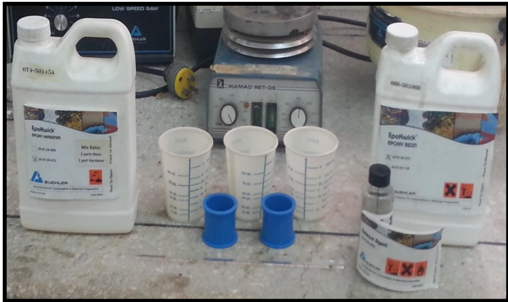
Foto N°. 15: Reactivos utilizados para el resinado. Mezcla Epokwick.
