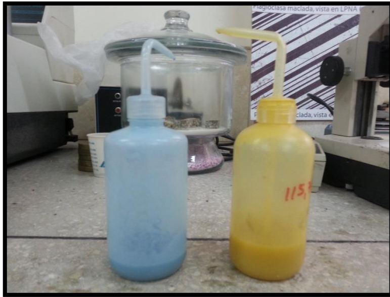
Foto N o . 18: Suspensión de diamante de 4 micrones (amarillo) y 6 micrones (azul).
