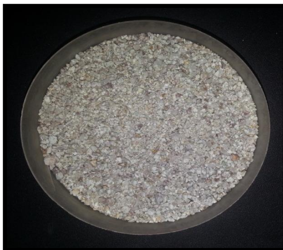
Foto N°. 21: Muestra de roca triturada y deslamada para el análisis mineralógico.
