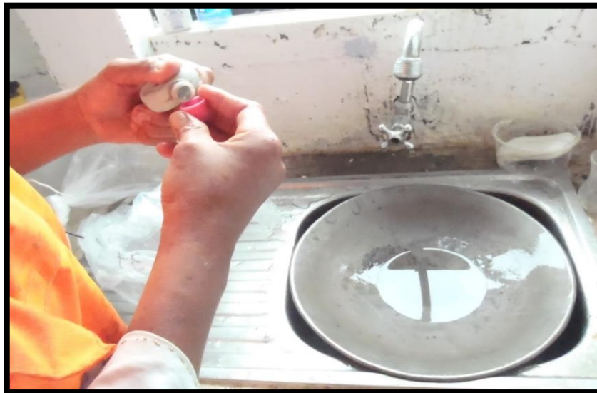
Foto N°. 29: Amalgamación con mercurio.
