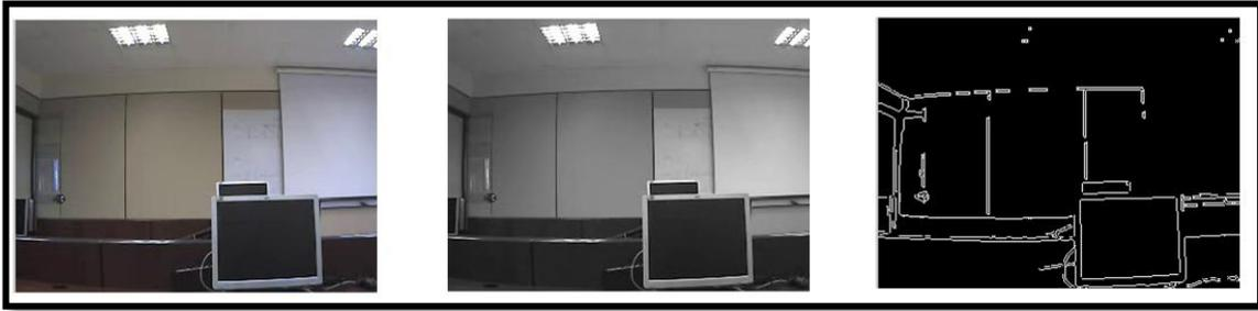
Fig. 2.18 Detección de contornos mediante algoritmo de Prewitt.
