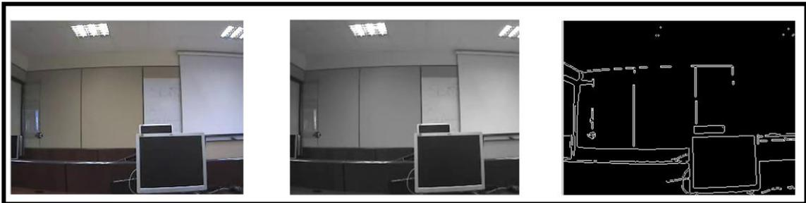
Fig. 2.19 Detección de contornos mediante algoritmo de Sobel.
