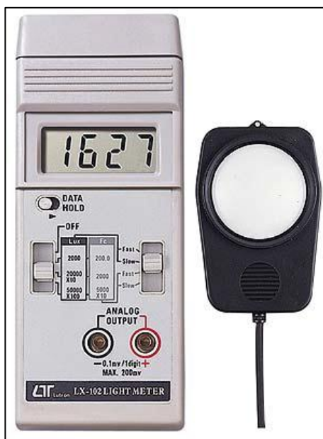
Fig. 2.1 LX-102 medidor de luz luxómetro profesional, [en línea] http://www.kelab.com.hk/newweb/TAIWANequip/LUTRONseries/2007Lutron/LX-102.pdf
