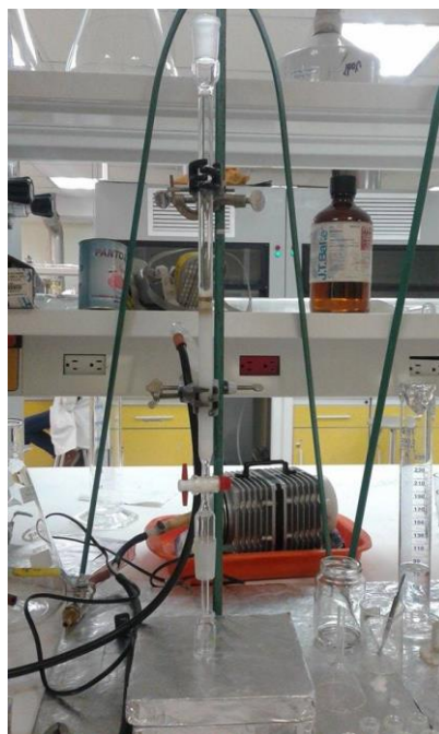
Figura 7. Montaje y elución en columna abierta. Fuente: Autoras. Elaboración: Autoras
