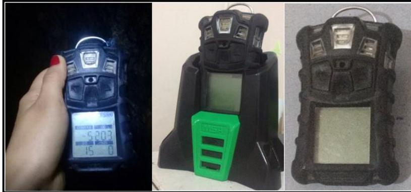
Ilustración 6. Medidor multigases Altaír 4X.
