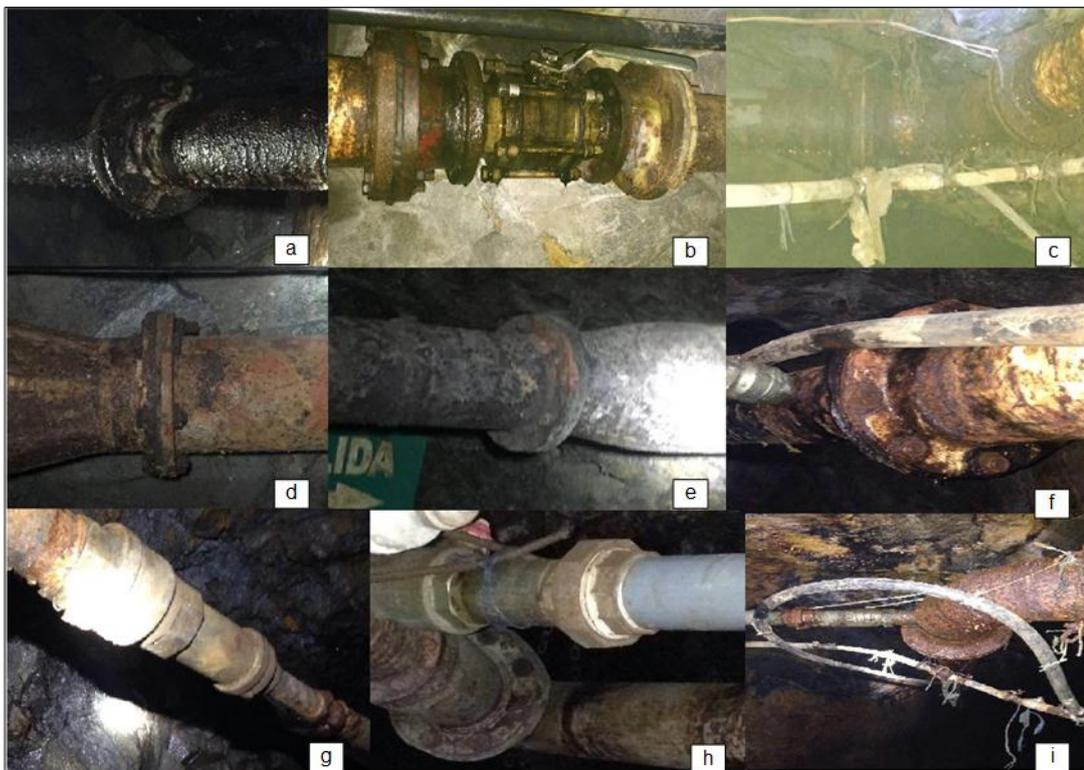
Ilustración 25. Accesorios en el circuito de aire comprimido Frente 4. Uniones en tuberías de hierro (a y f); llave cortadora en tubería de hierro (b); codos de hierro (i y c); uniones de aumento de diámetro (d y e); uniones universales en tuberías de PVC (g y h).
