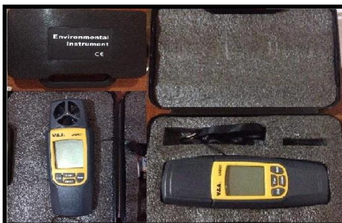
Ilustración 5. Anemómetro para caracterizar el aire VA8021
