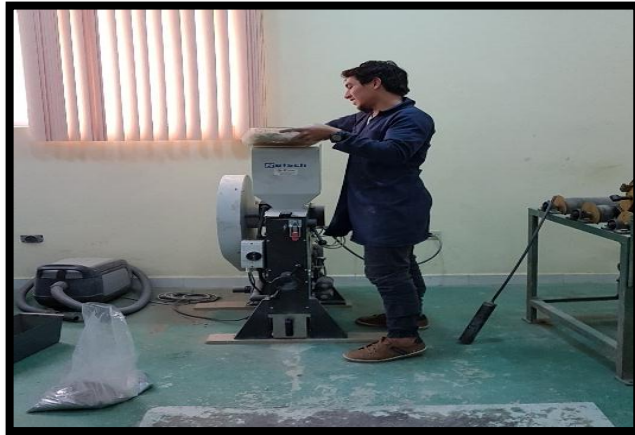
Ilustración 16. Trituración de la muestra de cabeza. Fuente: Michael Armijos, 2017 Elaboración: Michael Armijos, 2017
