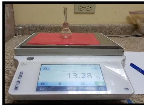
Ilustración 20. Determinación de peso específico por picnómetro.
