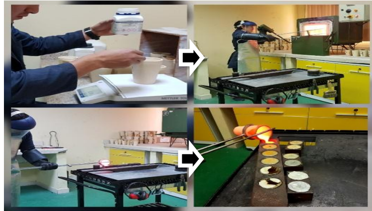
Ilustración 25. Proceso de fundición de muestras pulverizadas. Fuente: Michael Armijos, 2017 Elaboración: Michael Armijos, 2017
