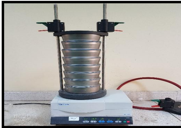
Ilustración 23. Tamices utilizados para el análisis de malla valorada.
