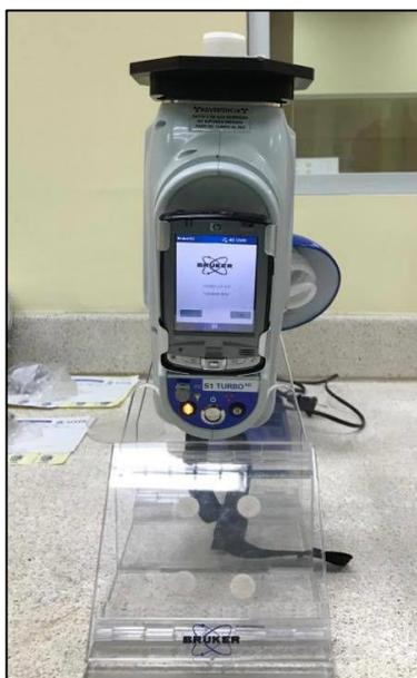
Figura 20. Equipo portátil de Fluorescencia de Rayos X
