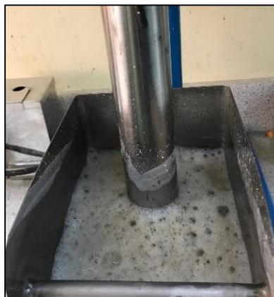
Figura 9. Aireación en celda de Flotación.
