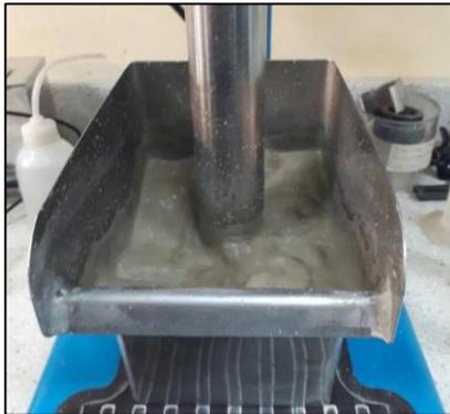
Figura 8. Pulpa en celda de flotación.
