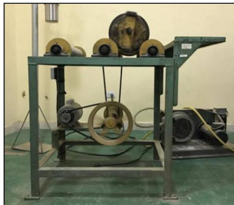
Figura 16. Molino de Bolas Batch.
