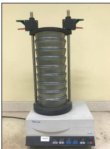
Figura 17. Análisis granulométrico en seco.
