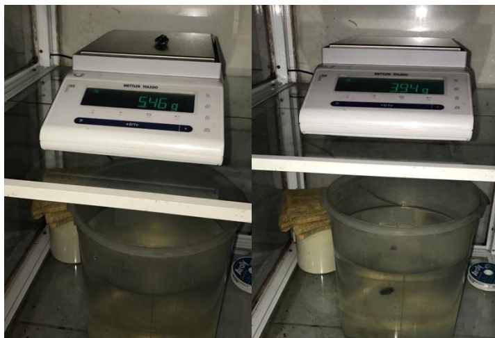
Figura 2 Ensayos de laboratorio realizados. Densidad y peso volumétrico. (Izq a Der) Fuente: Gonzalo Mora Mora Elaboración: Gonzalo Mora Mora
