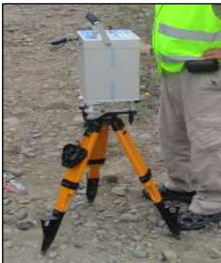
Figura 7. Gravímetro Scintrex CG-5 Autograv.
