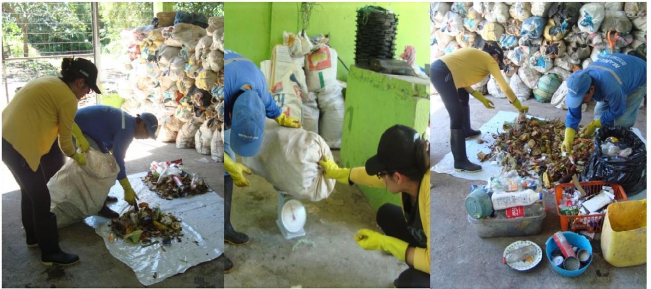
**Figura 5.2** Peso de la Muestra de aproximadamente 50 kg y segregación de los residuos sólidos.
