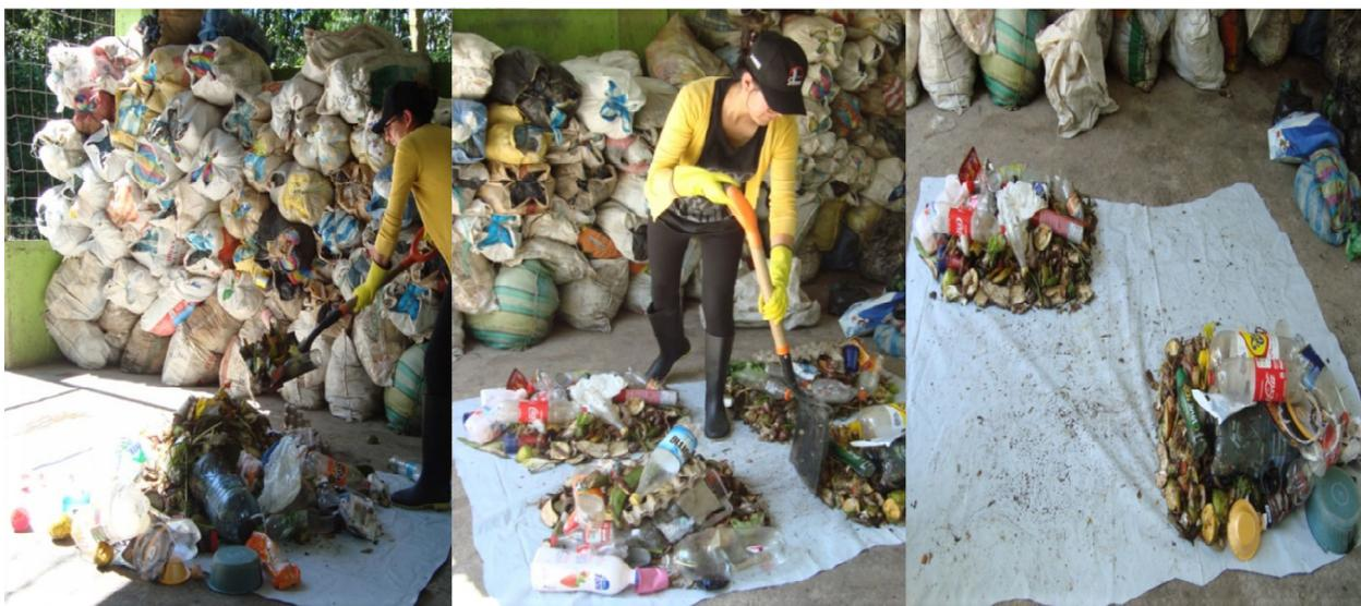
**Figura 10.** Homogeneización de Muestras y Método de Cuarteo.
